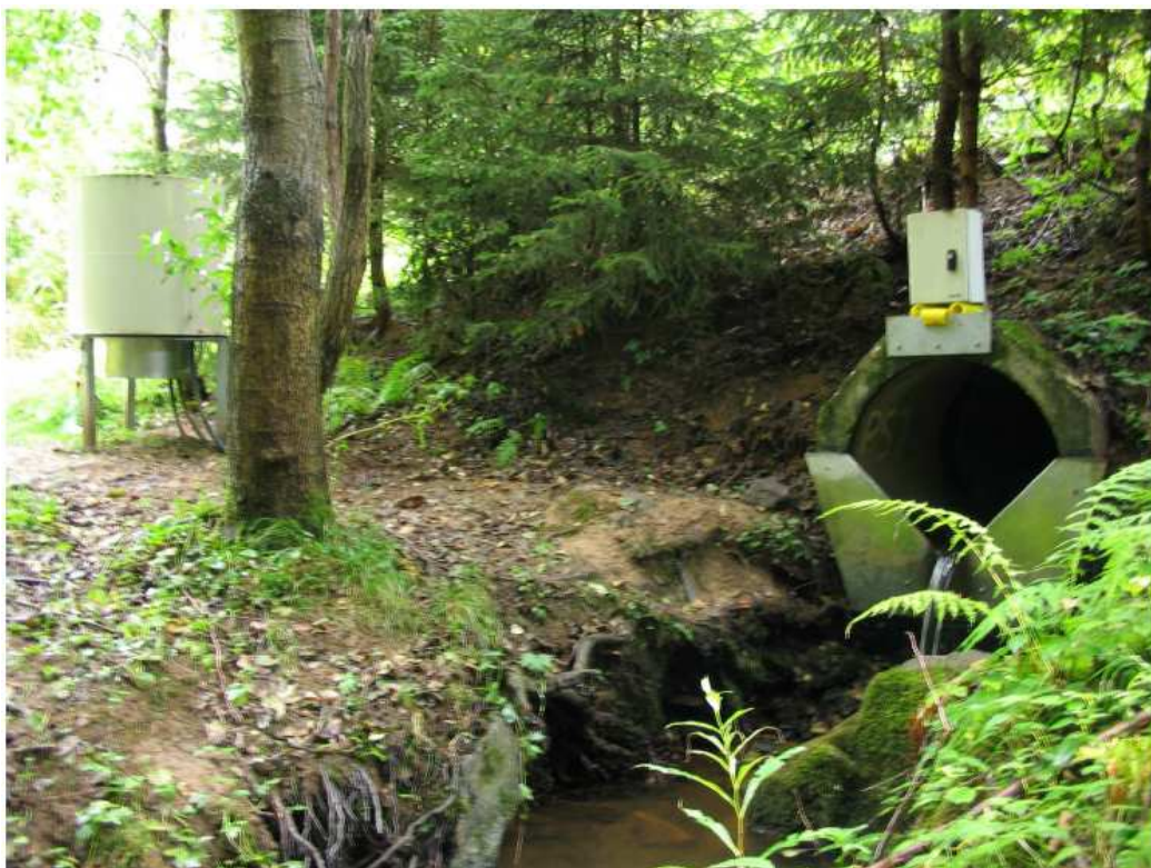
Obr. č. 15: Thompsonův přepad s ultrazvukovou sondou a dataloggerem vpravo a vzorkovač ISCO pod ochranným krytem vlevo. Zdroj: (KVÍTEK A KOL., 2008)
