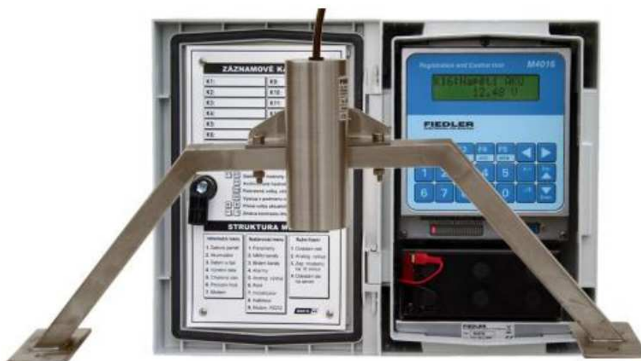
Obr. č. 13: Sestava pro měření průtoku od firmy Fiedler-Mágr. V popředí ultrazvukový snímač hladiny US1200 se stojanem a v pozadí registrační jednotka M4016.
