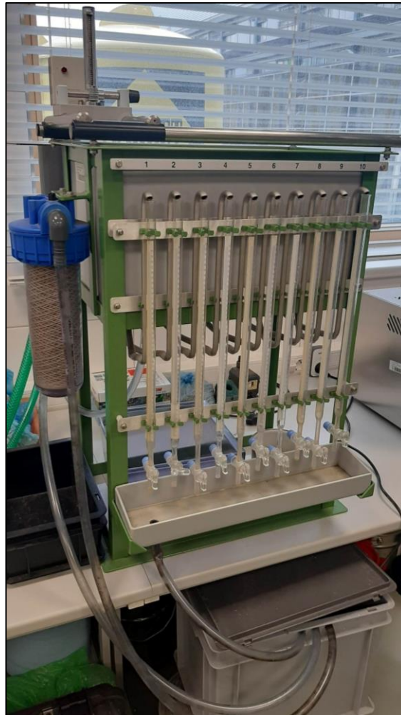
Obr. 13 – Celkový pohled na laboratorní permeametr (vlevo) a detail kohoutků na byřetách (vpravo)
