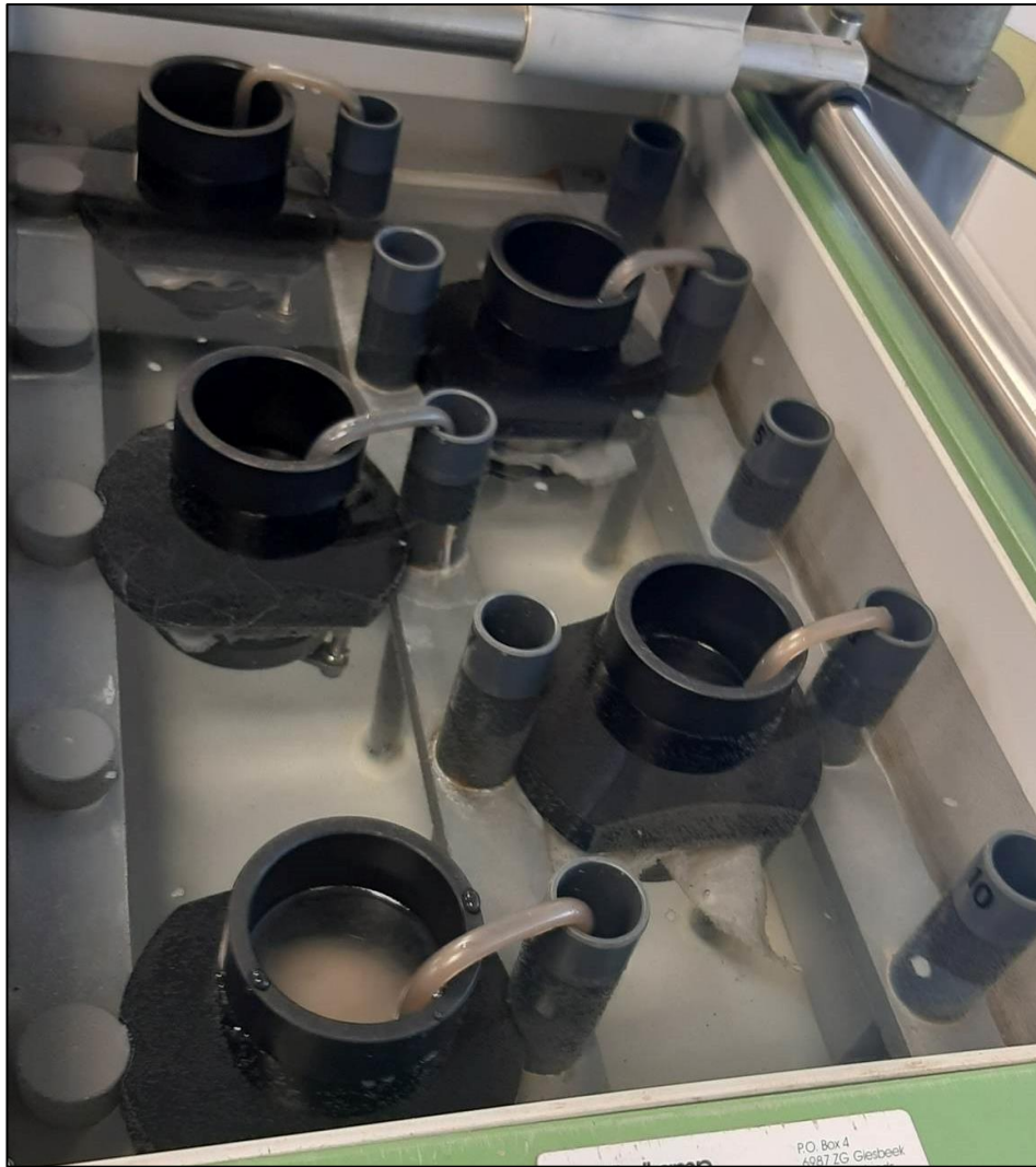
Obr. 11 – Správná instalace násosek v laboratorním permeamtru
