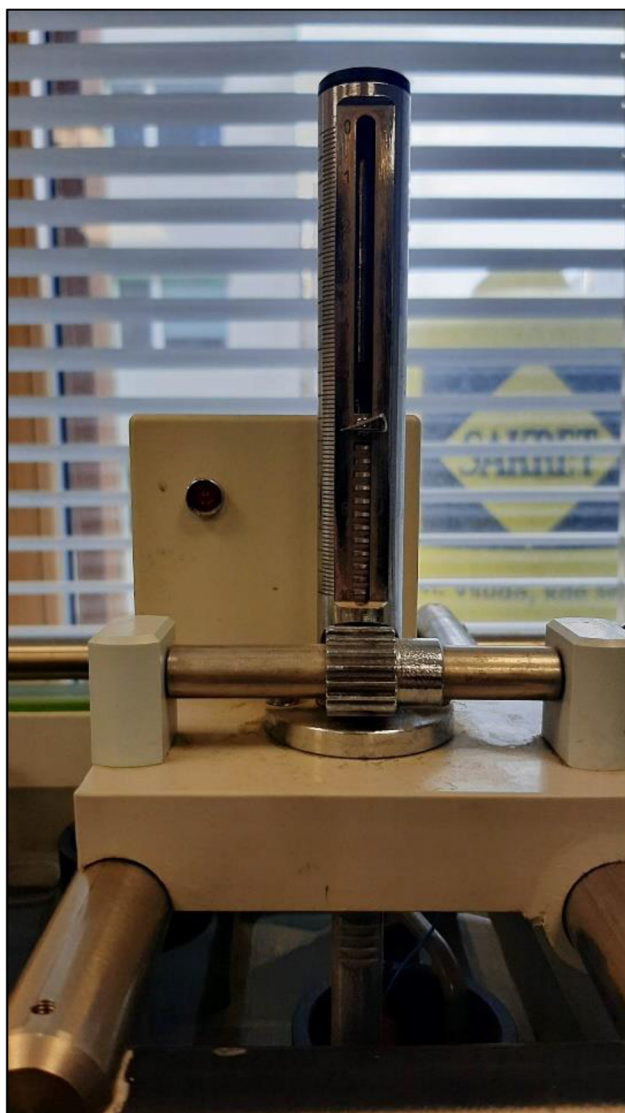
Obr. 12 – Vestavěné měřidlo výšky hladiny v laboratorním permeamtru
