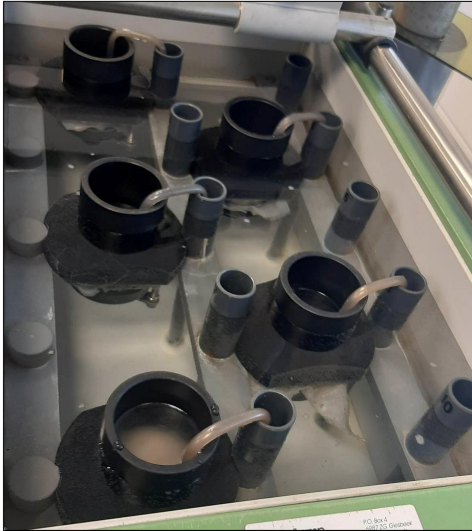
Obr. 11 – Správná instalace násosek v laboratorním permeamtru
