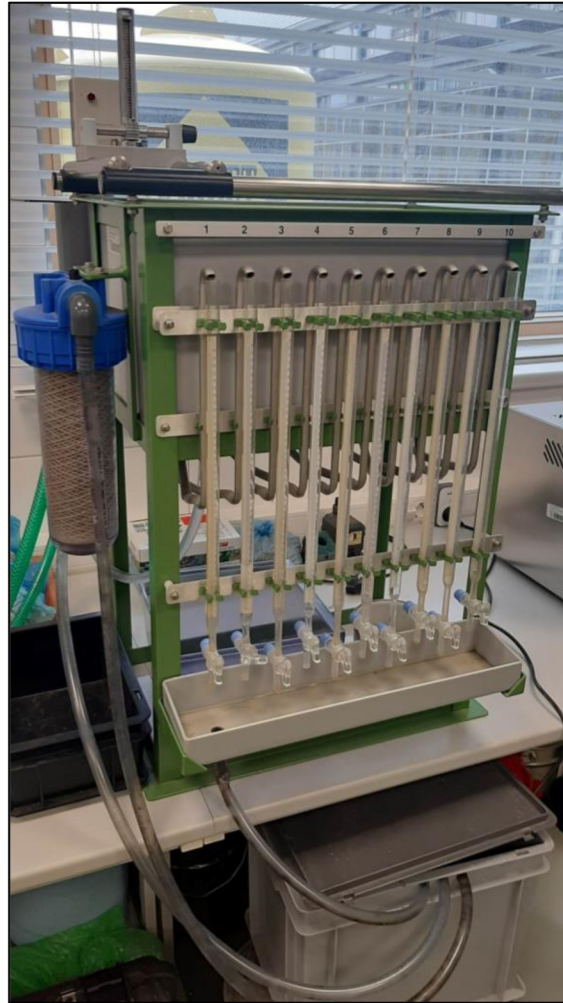
Obr. 13 – Celkový pohled na laboratorní permeametr (vlevo) a detail kohoutků na byretách (vpravo)
