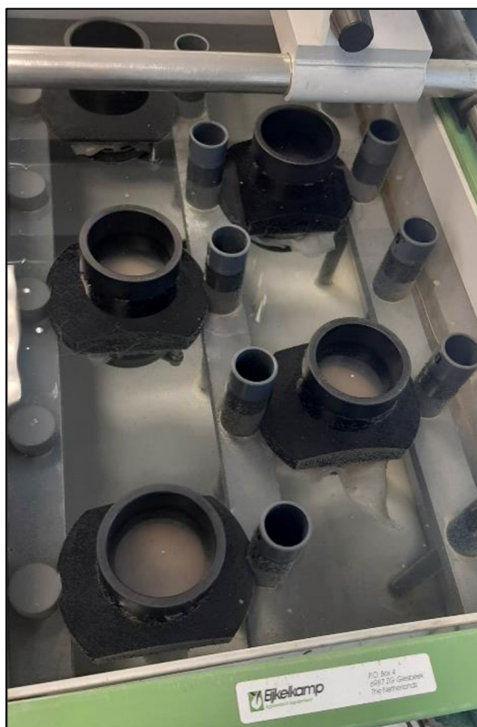
Obr. 10 – Saturování vzorku v nádobě s demineralizovanou vodou (vlevo) a saturování vzorků v laboratorním permeamtru (vpravo)
