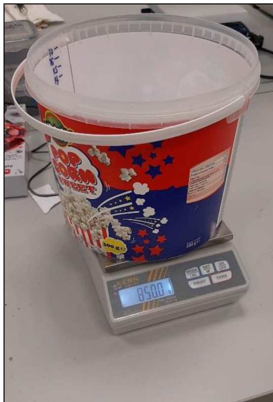
Obr. 5 – Vážení slévárenského písku (vlevo) a vážení směsi slévárenského a mikromletého písku (vpravo)
