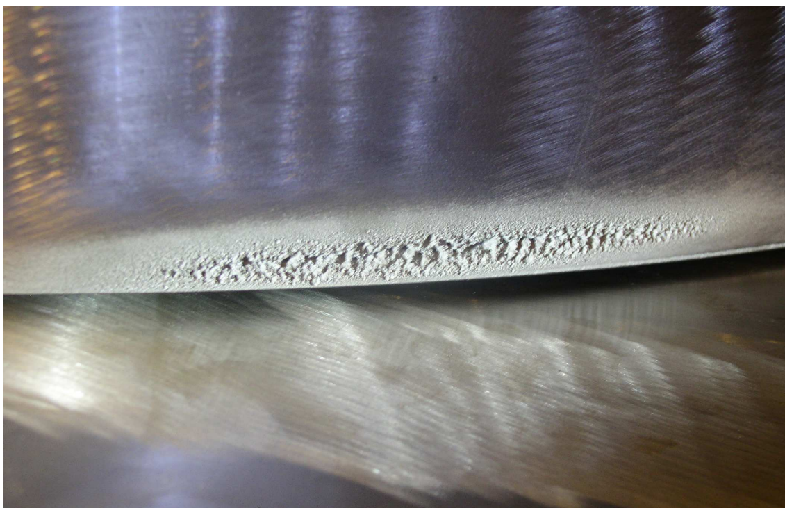
Obr. 25 Poškozená oběžná lopata kavitací, foto autor
