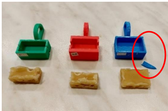
Obr. 37 – zlomená stěna vany
