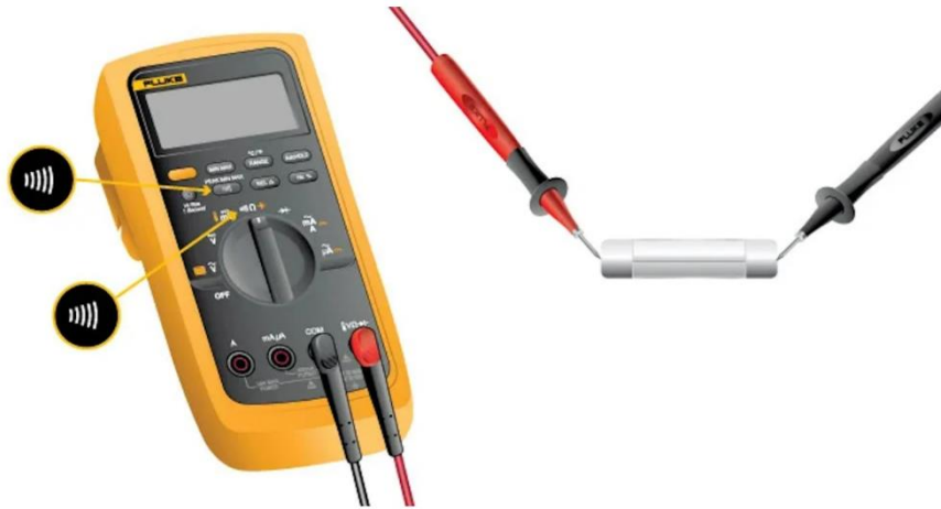
Obr. 2-5 Nastavení multimetru Fluke pro měření kontinuity [17]
