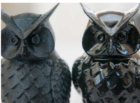
Obr. 8-8 Chemické leštění (vlevo před, vpravo po leštění) [23]
