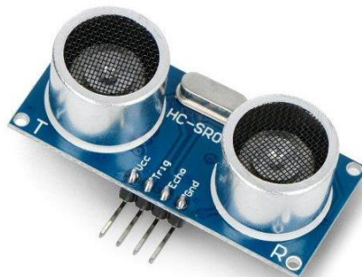
Obr. 2-6 Ultrazvukový senzor s odděleným vysílačem a přijímačem [15]
