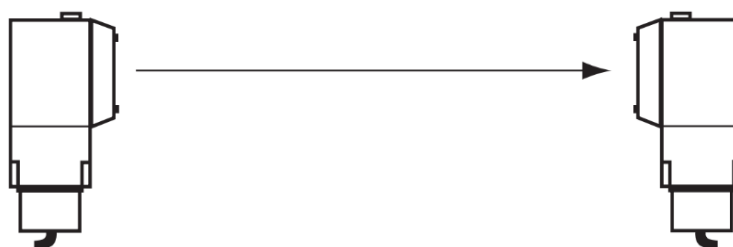
Obr. 2-3 Použití přímé detekce bez reflexní plochy [1]
