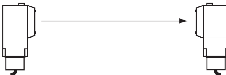
Obr. 2-3 Použití přímé detekce bez reflexní plochy [1]
