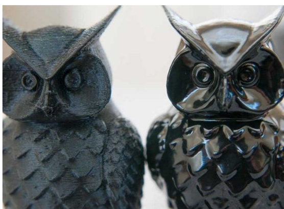
Obr. 8-8 Chemické leštění (vlevo před, vpravo po leštění) [23]
