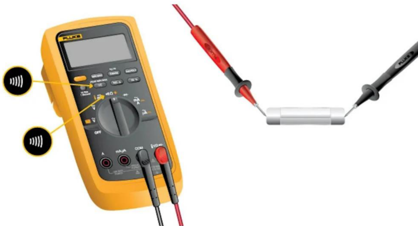
Obr. 2-5 Nastavení multimetru Fluke pro měření kontinuity [17]
