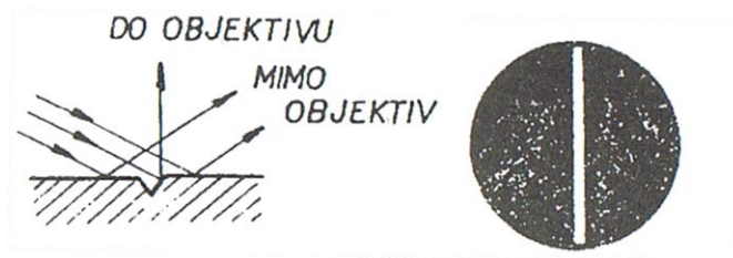
Obr. 21: Schéma osvětlení vzorku při pozorování v tmavém poli [4] (převzato a upraveno)
