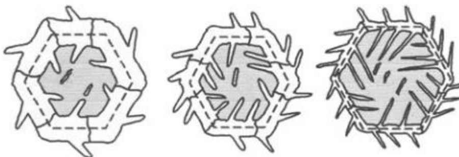
Obr. 15: Schematické znázornění Widmannstättenovy struktury v rámci austenitického zrna [9] (převzato a upraveno)
