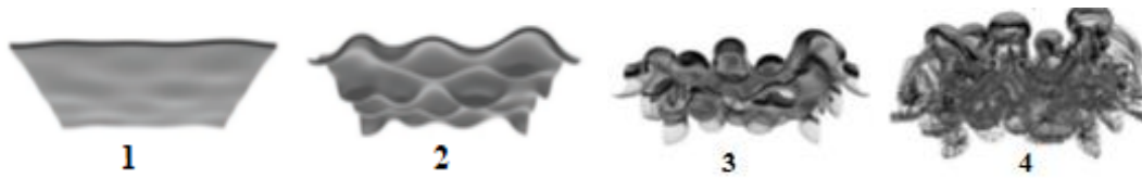
Obrázek 4: Schématické zachycení vzniku Rayleigh-Taylorovy nestability [5].
