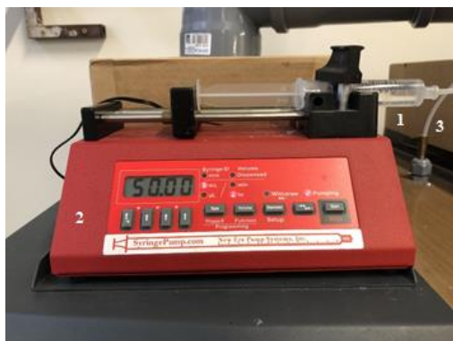
Obrázek 15: Detail dávkovacího zařízení dávající polymerní roztok do spinnerety. 1 - injekční stříkačky, 2 - dávkovací pumpy, 3 - hadičky vedoucí do spinnerety.
