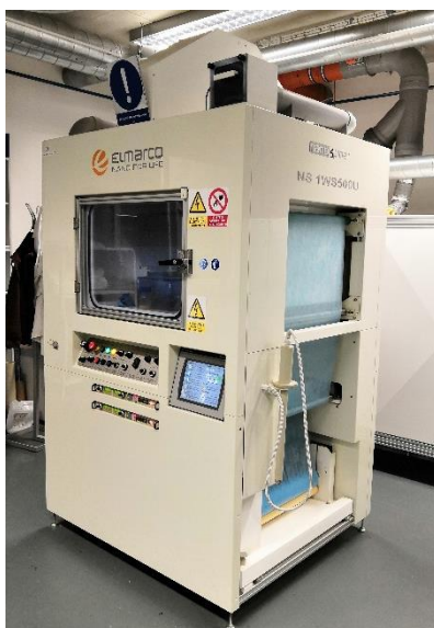
Obrázek 16: Zařízení Nanospider™ české značky Elmarco.
