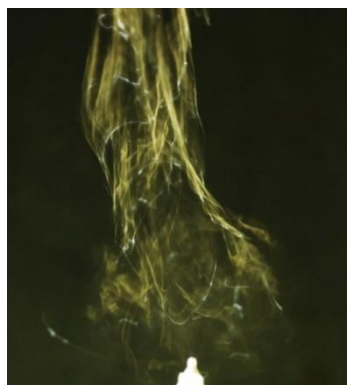
Obrázek 9: Nanovláknenný oblak vytvořený při elektrostatickém zvlákňování střídavým proudem bez použití uzemněného kolektoru [21].
