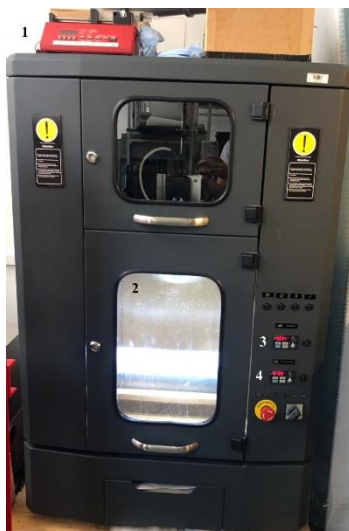
Obrázek 12: Zařízení Nanocentrino turecké firmy Areka Group. 1 - dávkovací zařízení, 2 - zvlákňovací komora, 3 - ovládání otáček spinnerety, 4 - ovládání otáčení kolektoru.
