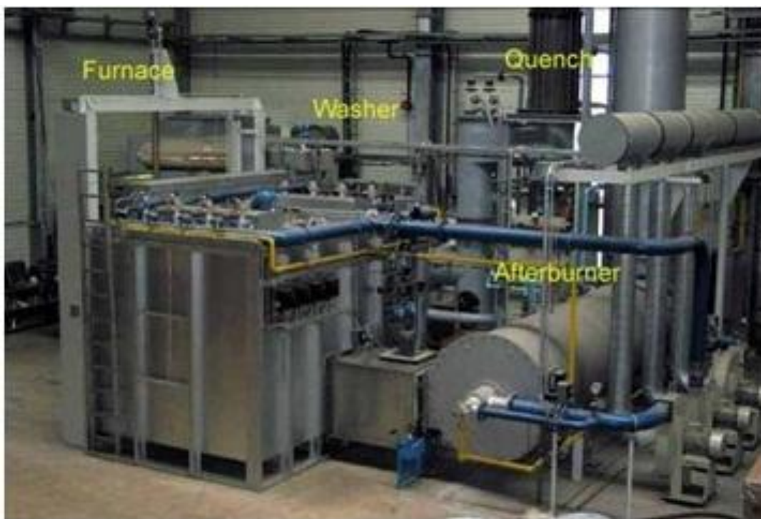
Obr. 5 Recyklační zařízení pro krystalické panely (Bechník, 2011)
