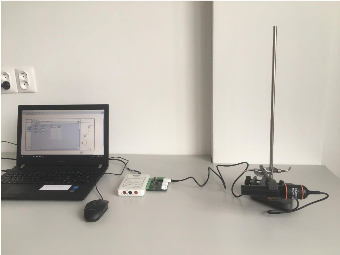
Obrázek 40 – Měření absorpčního koeficientu záření beta – Uspořádání
