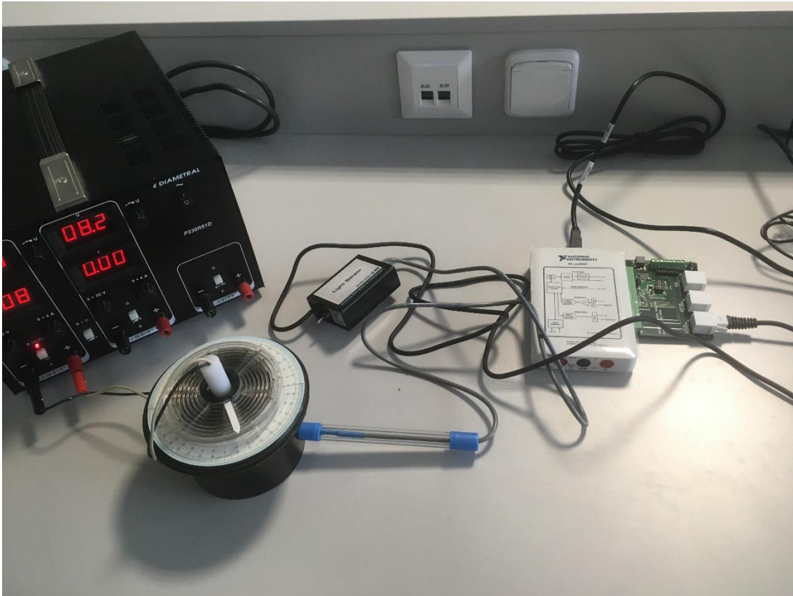
Obrázek 73 – Měření osvětlení – Zapojení hardware
