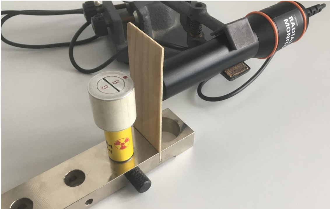
Obrázek 48 – Měření absorpčního koeficientu záření beta – Uspořádání
