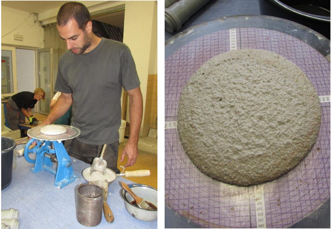
Obr. 4-13 Zkouška stanovení konzistence (střásací stolek).
