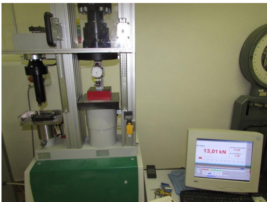
Obr. 7-5 Lis FORM+TEST 200 kN, na kterém byly provedeny statické zkoušky.
