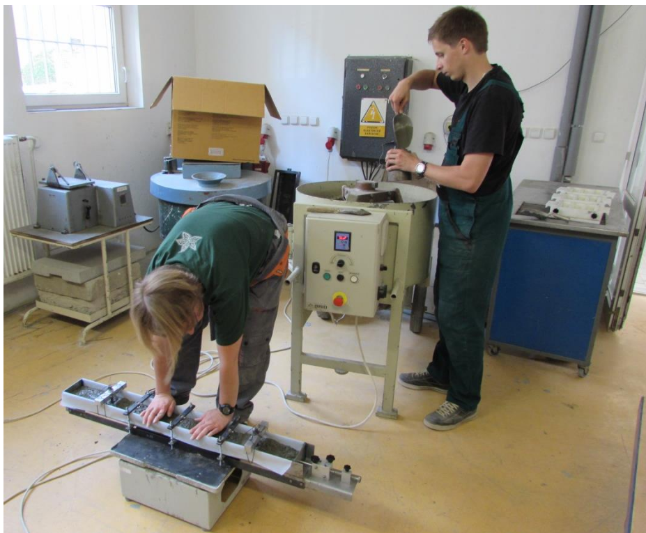
Obr. 7-2 Zhutňování čerstvé směsi ve formě.
