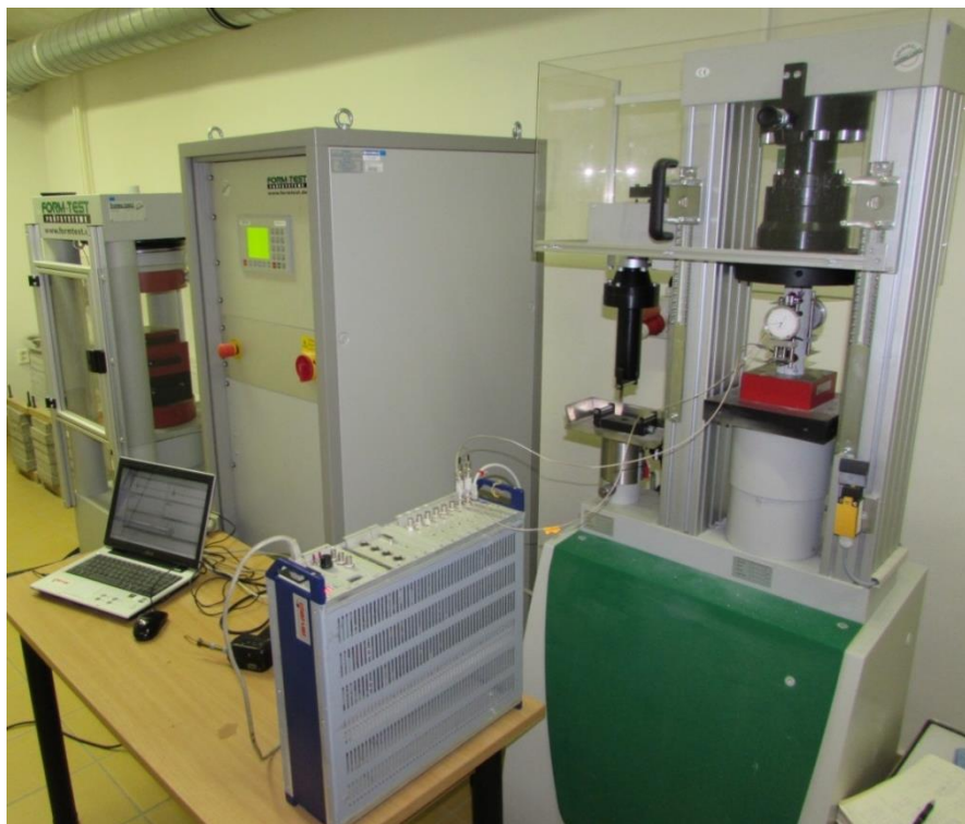
Obr. 7-6 Ukázka měření statického MP a AE.
