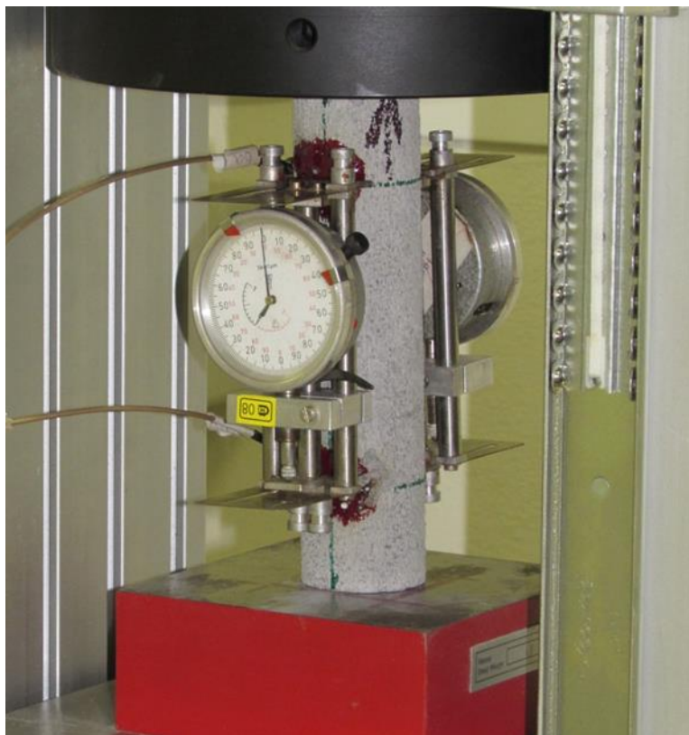
Obr. 3-8 Zkušební těleso s osazenými tenzometry připravené ve zkušebním lisu.
