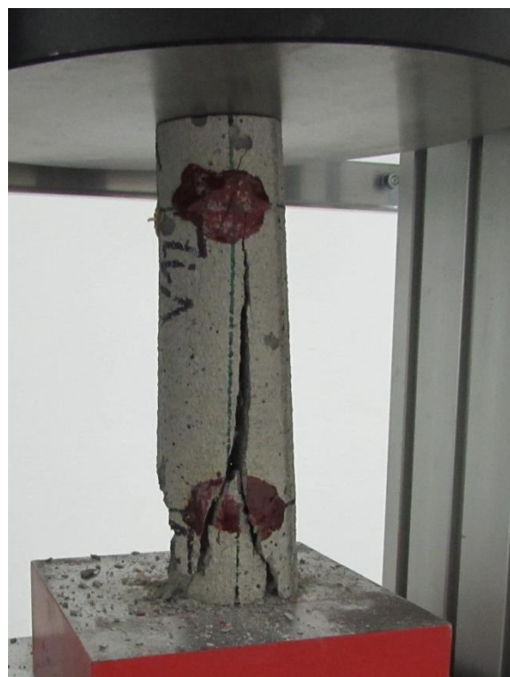
Obr. 4-17 Zkušební těleso po statické zkoušce.
