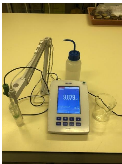
Obr. 6: laboratorní stolní pH metr (Zelinka, 2024)
