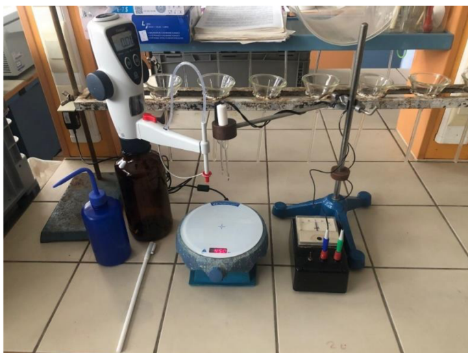
Obr. 7: Měření C_{ox} (Zelinka, 2024)
