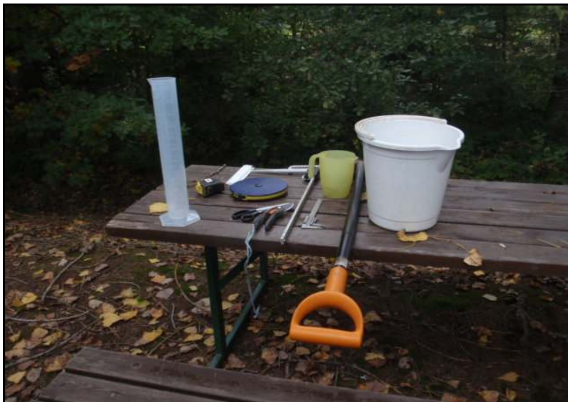
Fotografie č. 36: Pomůcky k vyzvednutí a měření vzorků
