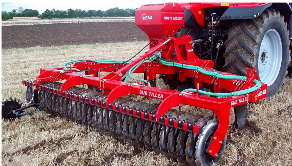
Obrázek 11 Kypřič Sub-tiller se secím ústrojím Multi-Seeder značky HE-VA
