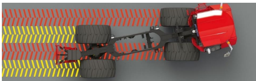
Obrázek 4 Znáznornění krabího chodu stroje Holmer Terra Variant 600 eco
