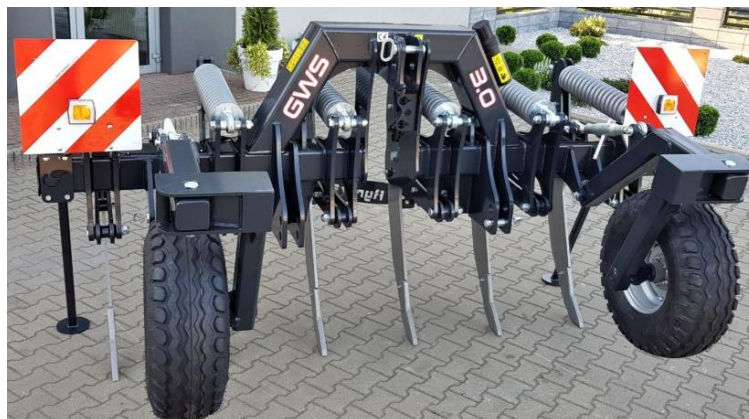
Obrázek 12 Podrývák GW 6 s pracovním záběrem 3 m od firmy AGRO-TOM
