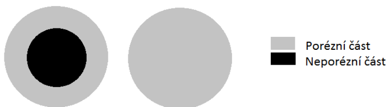
Obr. 5: Struktura core – shell částice (vlevo) a plně porézní částice (vpravo)
