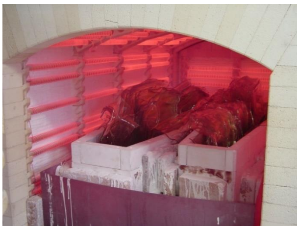
Obrázek 5: Formy se sklem v tavicí peci [54]
