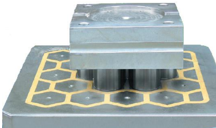
Obr. 3.18 Upnutí obrobku na EPMU s pólovými nástavci 13 .
