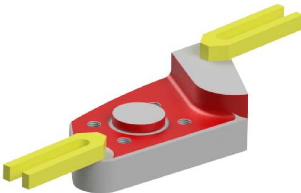
Obr. 3.12 Znázornění první polohy upnutí při dokončovacím frézování.
