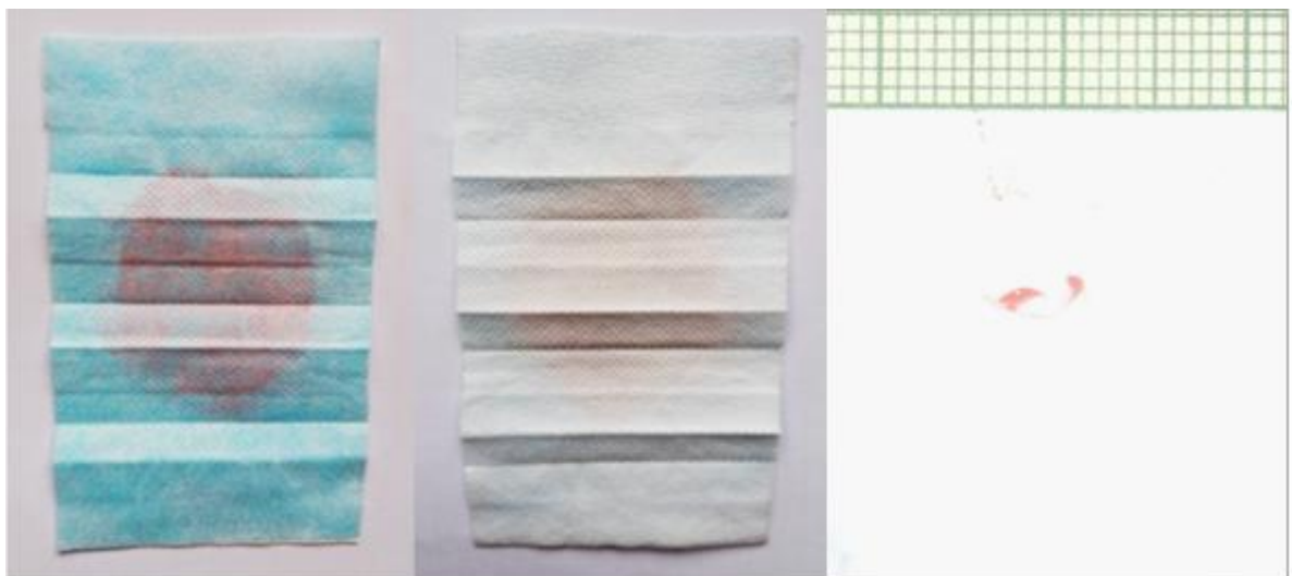
Obrázek 26 Prostup obarveného kaseinu zdravotnickou rouškou: vlevo vnější vrstva, uprostřed vnitřní vrstva, vpravo absolutní filtr
