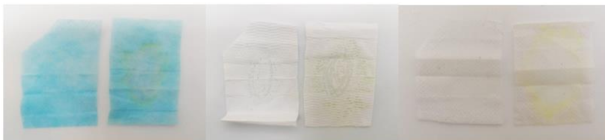
Obrázek 23 Detekce kaseinu kyselinou dusičnou (vlevo původní vzorek, vpravo vzorek s obsahem kaseinu)
