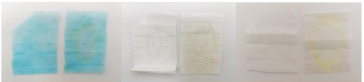
Obrázek 23 Detekce kaseinu kyselinou dusičnou (vlevo původní vzorek, vpravo vzorek s obsahem kaseinu)
