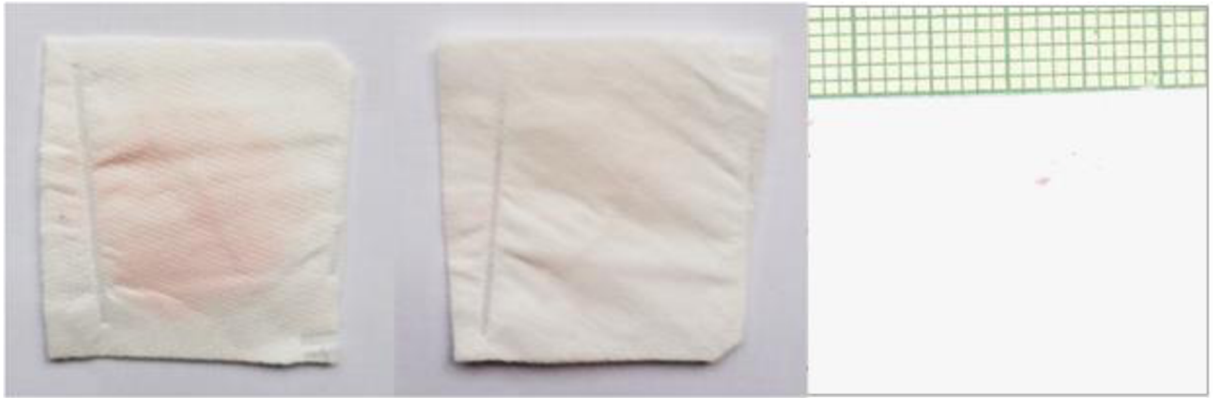
Obrázek 27 Prostup kaseinu respirátorem: vlevo vnější strana, uprostřed vnitřní strana, vpravo absolutní filtr
