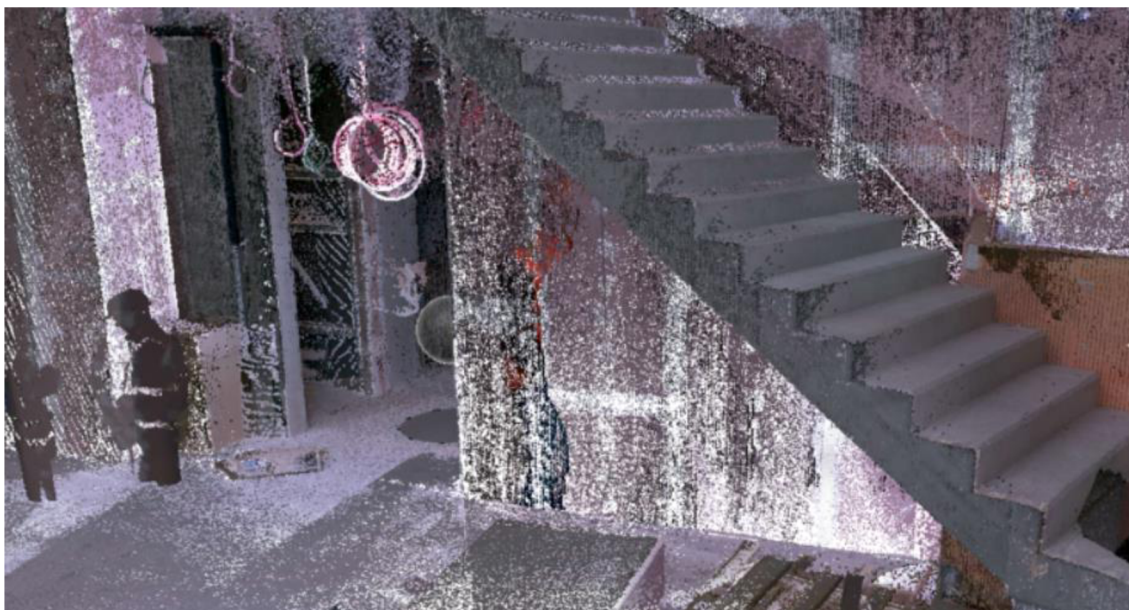
Obrázek 2: Příklad umístěného mračna bodů v modelu [Zdroj: 10]
