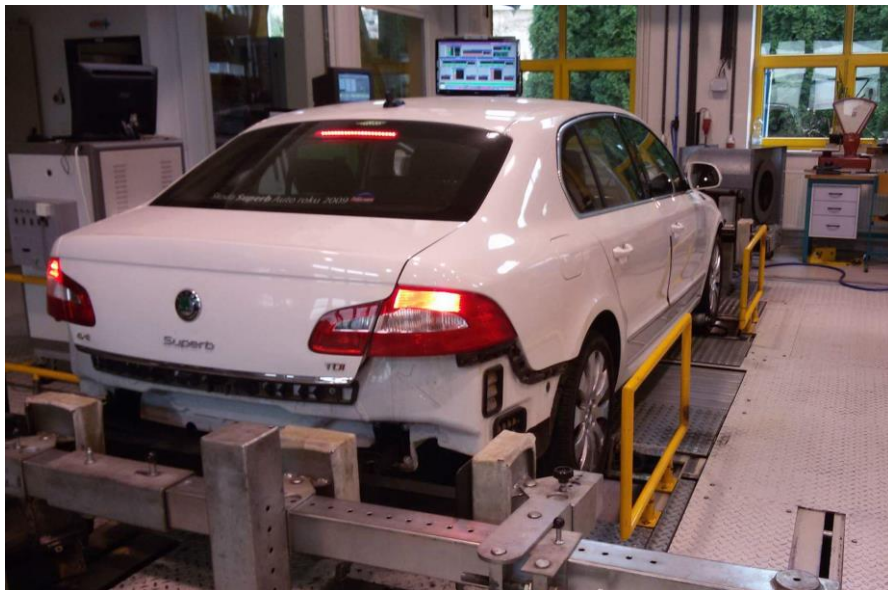
Obr. 22 Upevnění v zadní části měřeného vozidla
