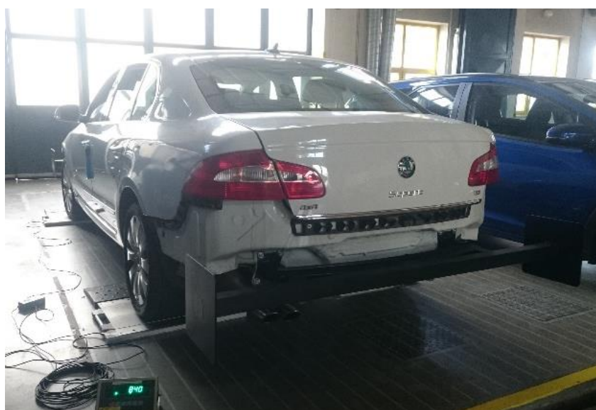
Obr. 19 Vážení kol vozidla
