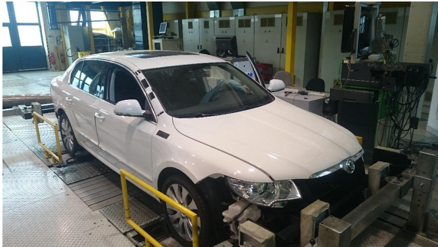
Obr. 21 Upevnění v přední části měřeného vozidla
