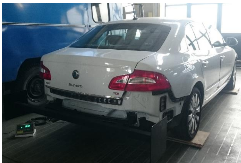
Obr. 20 Vážení kol vozidla
