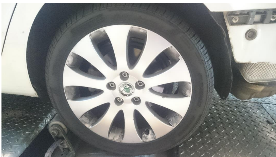
Obr. 16 Kolo vozidla na válci dynamometru s rolnou snímače otáček
