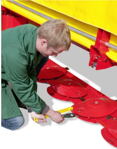
Obr. č. 2 Výměna nožů
