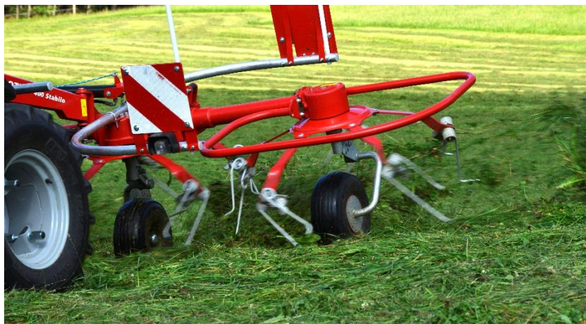
Obr. č. 7 Inovované prsty hrabice rotorového obraceče
