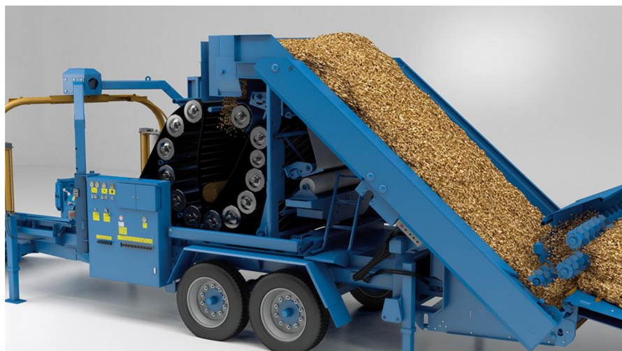
Obr. č. 14 Schéma stacionárního kombinovaného lisu
