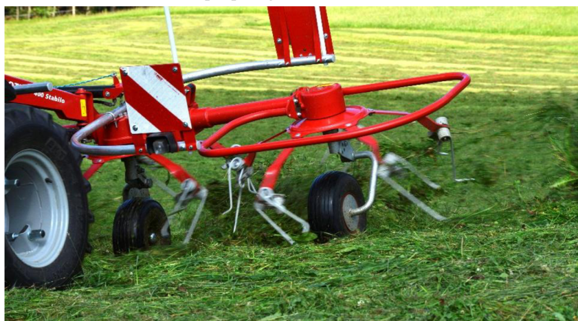
Obr. č. 7 Inovované prsty hrabice rotorového obraceče
