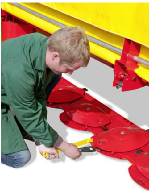
Obr. č. 2 Výměna nožů
