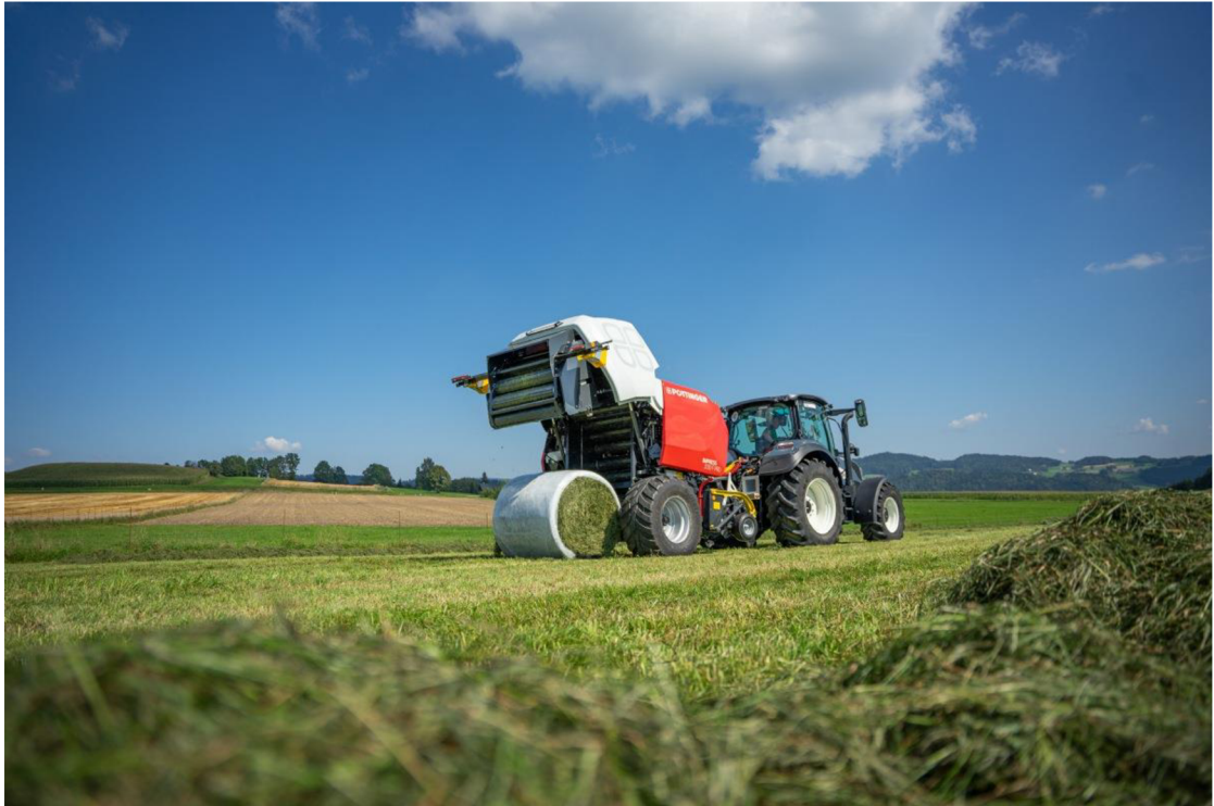
Obr. č. 13 Lis na válcovité balíky s konstantní komorou
