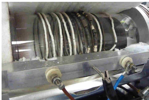
Obr. 4.3: Fotografie topné spirály vysokoteplotní aparatury pro výrobu grafenu. Topný odporový drát pro ohřev reaktoru je navinut okolo křemenné trubky a je připojen ke zdroji stejnosměrného proudu. Keramické válečky mezi závity topného odporového drátu zabráňují jeho zkratování.
