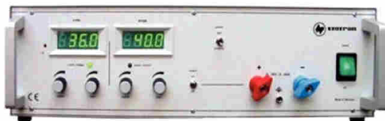
Obr. 4.4: Napájecí zdroj stejnosměrného proudu Statron 3256,1 s možností dálkového ovládání. Maximálního výkonu je možné dosáhnout při napětí 36 \text{ V} a proudu 40 \text{ A} . Ke zdroji je připojen topný odporový drát, který ohřívá reaktor až na teplotu 1050 \text{ }^\circ\text{C} .
