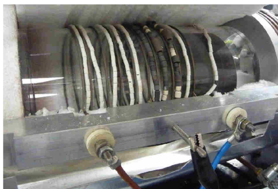
Obr. 4.3: Fotografie topné spirály vysokoteplotní aparatury pro výrobu grafenu. Topný odporový drát pro ohřev reaktoru je navinut okolo křemenné trubky a je připojen ke zdroji stejnosměrného proudu. Keramické válečky mezi závitů topného odporového drátu zabráňují jeho zkratování.
