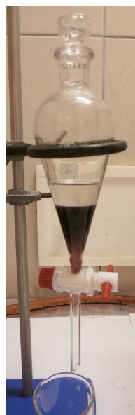
Obr. č. 5. Dělicí nádoba po extrakci
