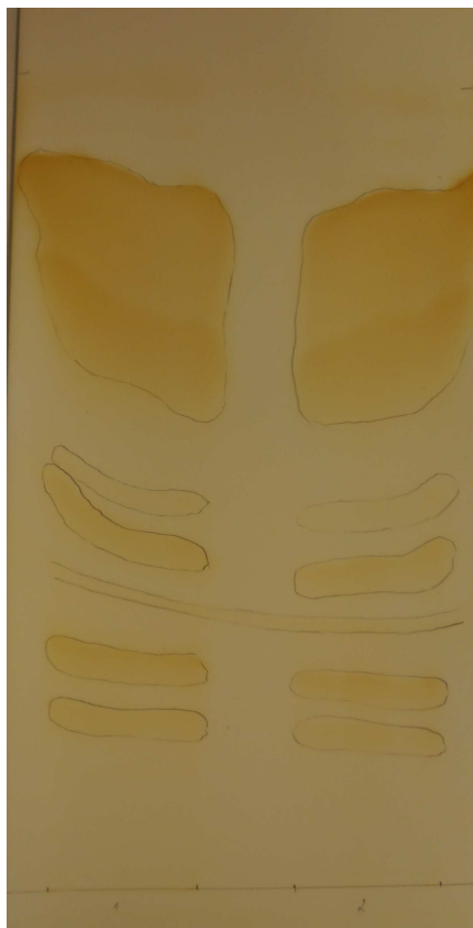
Obr. č. 7. TLC destička po vizualizaci jódem
