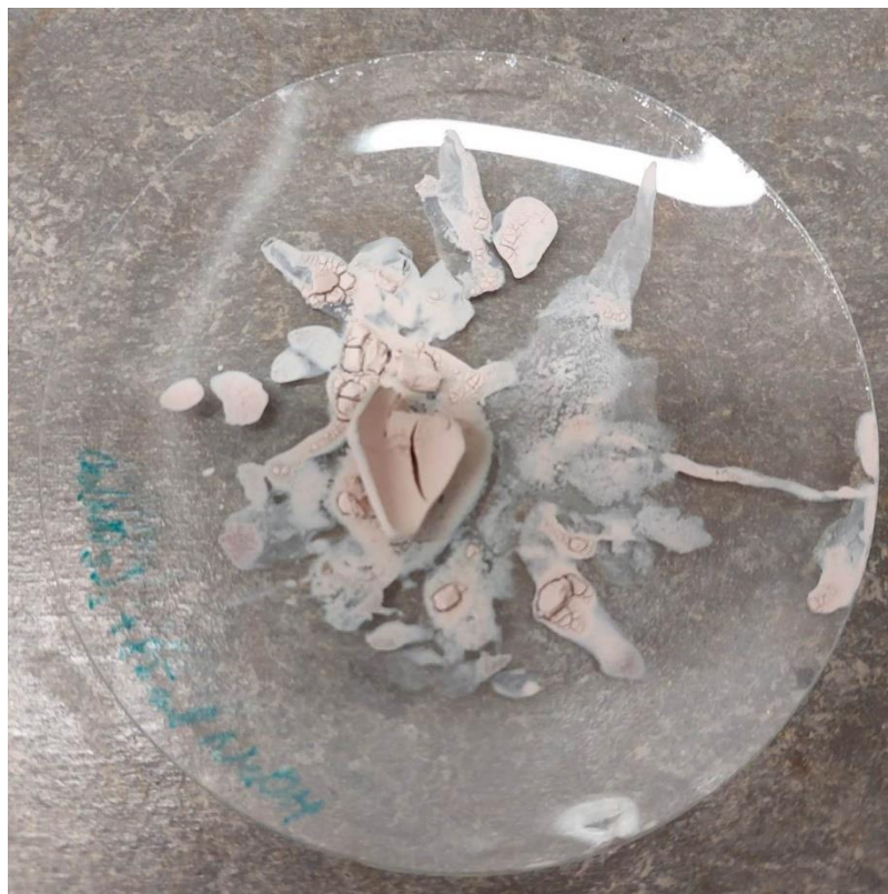
Obrázek 14: Produkt vzniklý vysušením hydroxidu kobaltnatého
