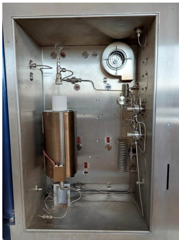
Obrázek 13: Pohled dovnitř reaktoru Microactivity EFFI, na kterém byla měřena katalytická aktivita při hydrogenační reakci \text{CO}_2 , v picce je umístěná křemenná kapilára
