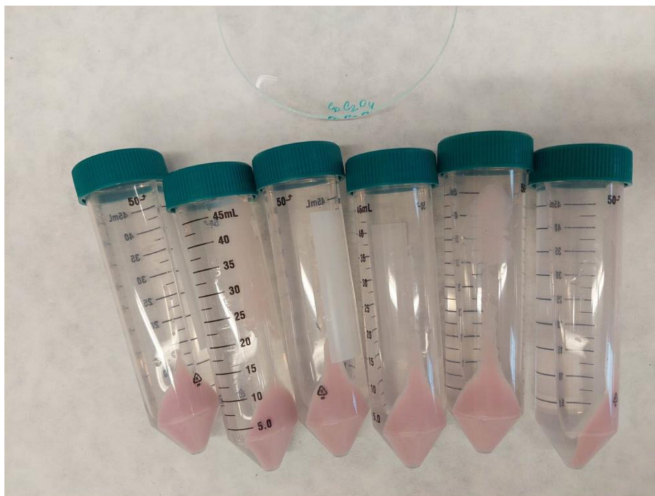
Obrázek 15: Šťavelan kobaltnatý odstředěný na centrifuze při 8000 otáčkách
