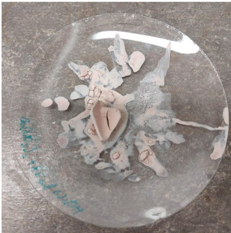
Obrázek 14: Produkt vzniklý vysušením hydroxidu kobaltnatého
