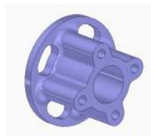
Obrázek 7 Upravené motorové lože.
