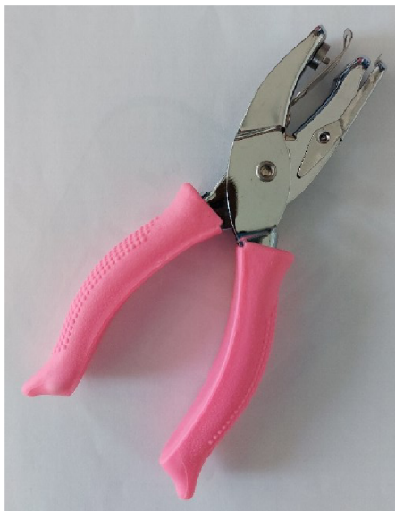
Obr. 16 Děrovací kleště používané pro vyřezávání vzorků z FTA karet.
