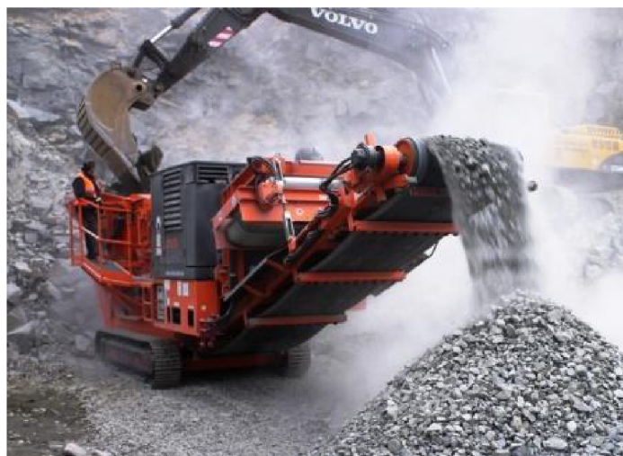
Obr. 2 Drcená sut', převzato z [5] (na obrázku drtič kamene a stavebního odpadu)
