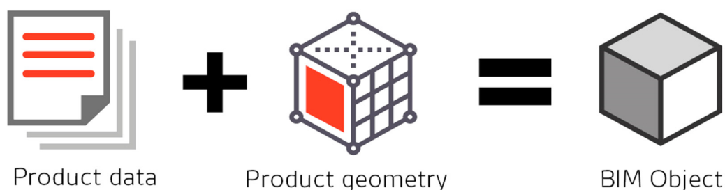
Obrázok 3: Skladba BIM objektu [7]
