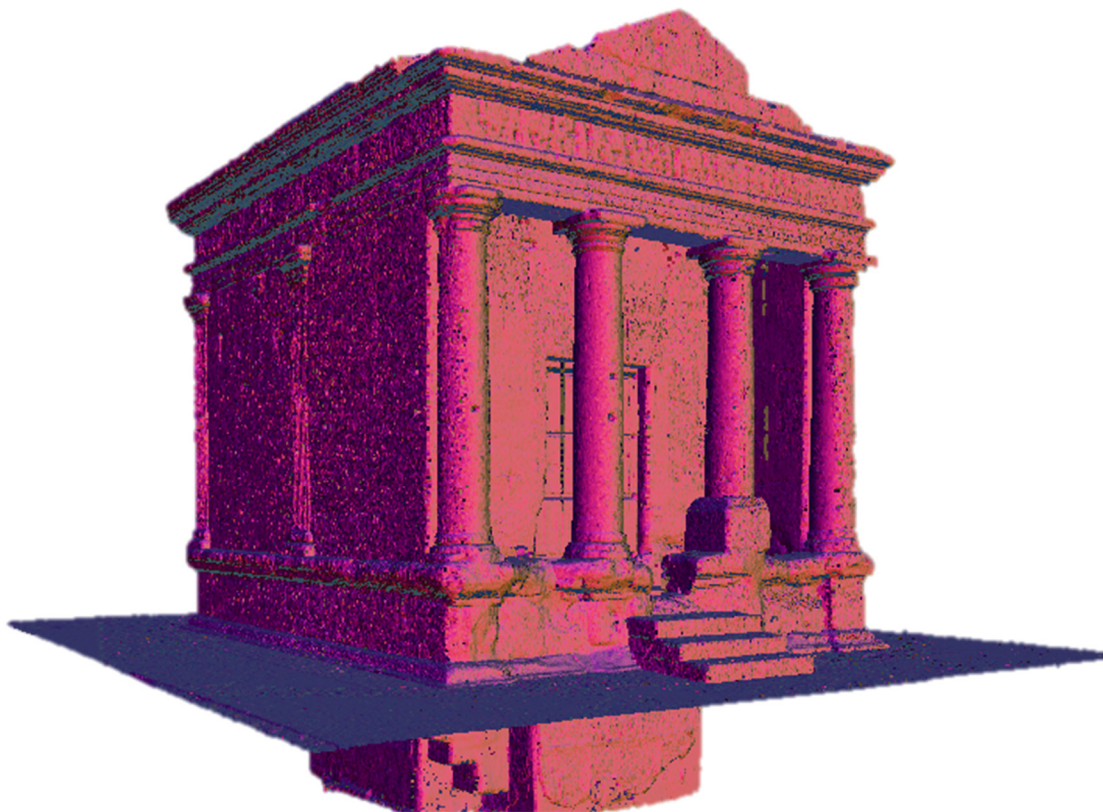
Obrázok 16: Mračno bodov z laserového skenovania
