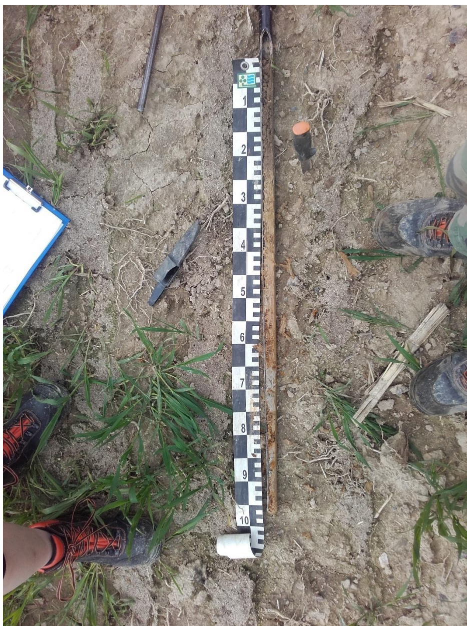
Obrázek 13 Půdní sondírka odebraného vzorku ze sondy č. 125 (Autor: L. Vlček)
