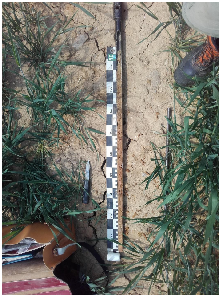
Obrázek 11 Půdní sondírka odebraného vzorku ze sondy č. 117 (Autor: L. Vlček)
