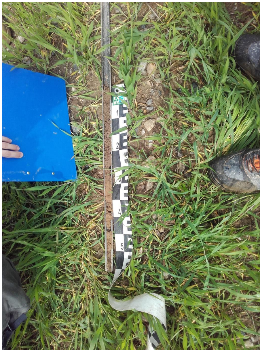
Obrázek 12 Půdní sondírka odebraného vzorku ze sondy č. 122 (Autor: L. Viček)
