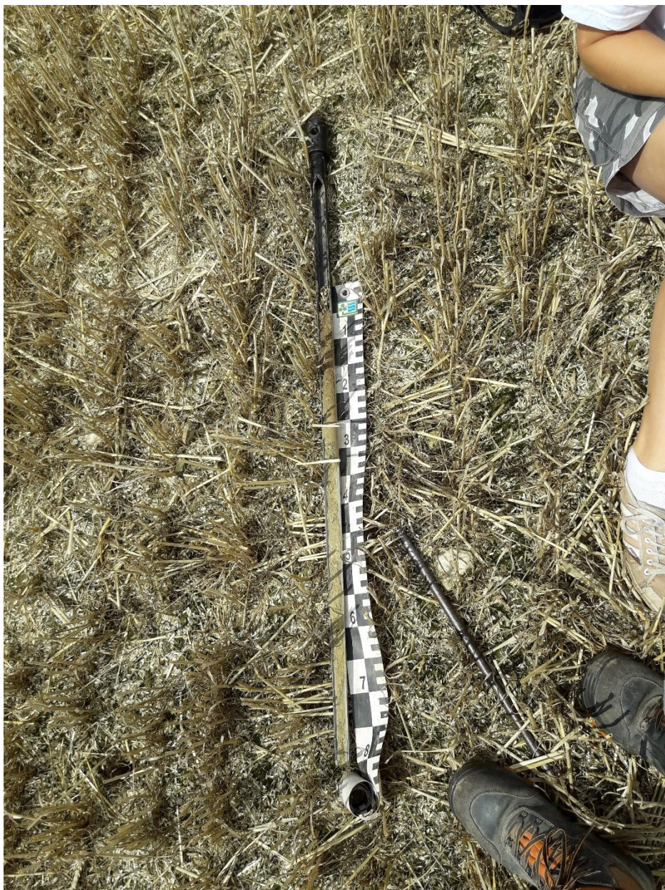
Obrázek 9 Půdní sondírka odebraného vzorku ze sondy č. 95 (Autor: L. Vlček)
