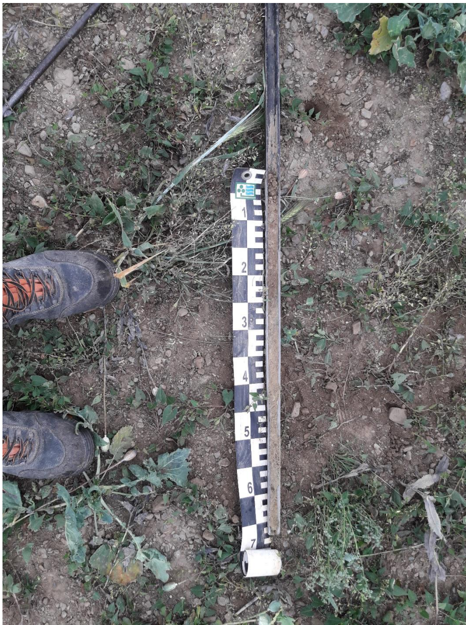
Obrázek 8 Půdní sondírka odebraného vzorku ze sondy č. 91 (Autor: L. Vlček)
