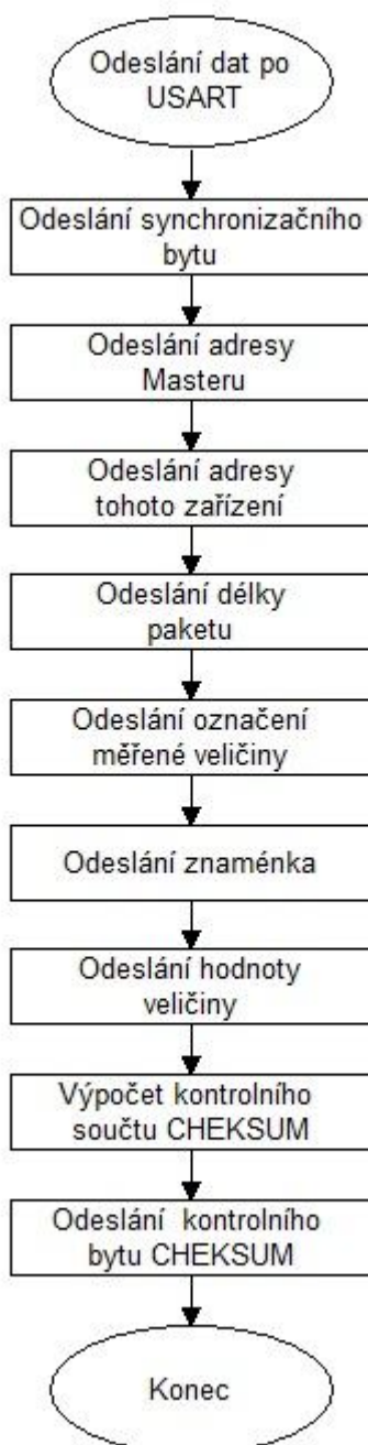
Obr. 51 Vývojový diagram odesílání dat po USART
