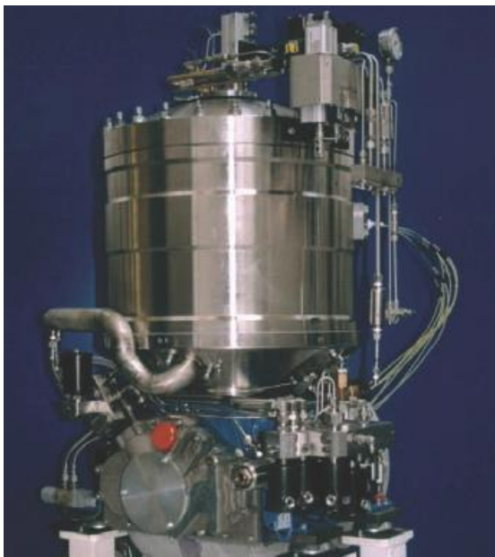
Obr. 29: Stirlingův motor V4-235 společnosti Kockums AB
