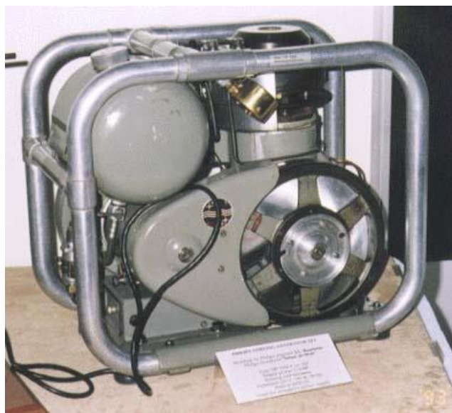
Obr. 18: Mobilní elektrocentrála společnosti N.V.Philips
