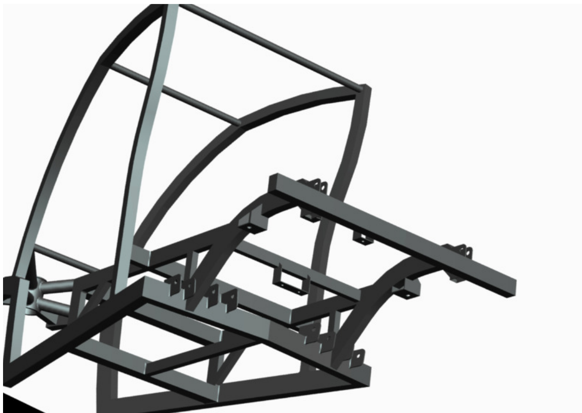
Obr. 4.5. Zadní část rámu s navařenými držáky pro uchycení nápravy, odpružení, motoru a korby
