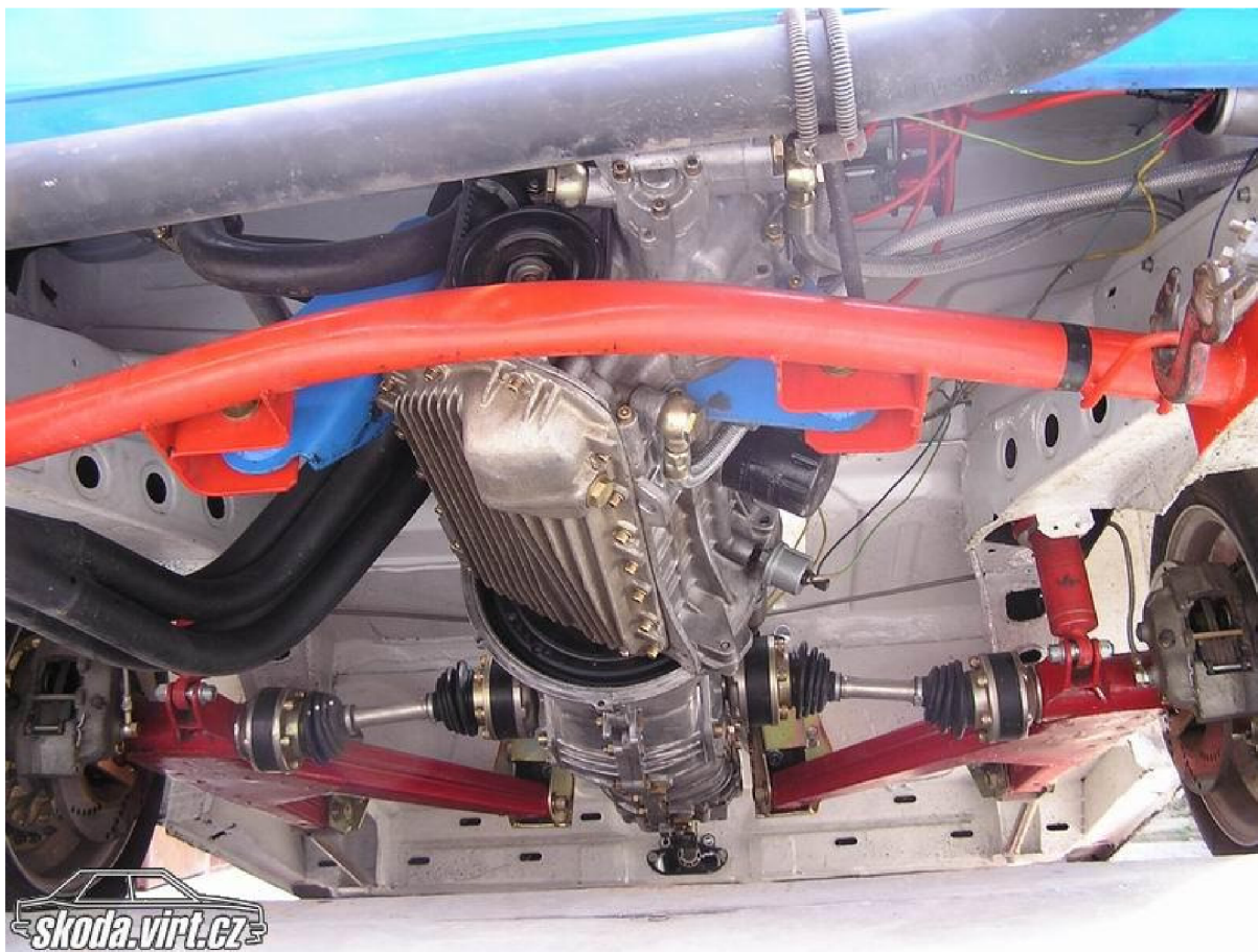
Obr. 3.17. Zadní kyvadlová úhlová náprava závodní škody 120 [24]
