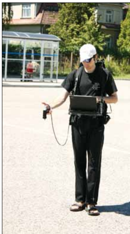
Obr. 5. Sběr kontrolních dat. Měření optických charakteristik vybraných povrchů spektrometrem Fieldspec-3 (Foto: Jan Hanuš, CVGZ AV ČR, v.v.i.).
