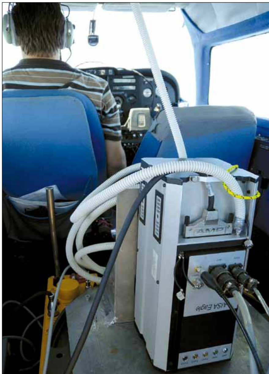
Obr. 4. Hyperspektrální skener AISA Eagle osazený v letadle (Foto: Jan Hanuš, CVGZ AV ČR, v.v.i.).
