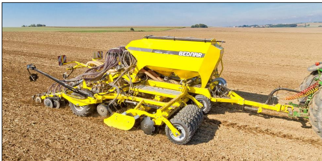
Obrázek 7: Stroj na minimalizační zpracování půdy (OmegaOO Ferti).
