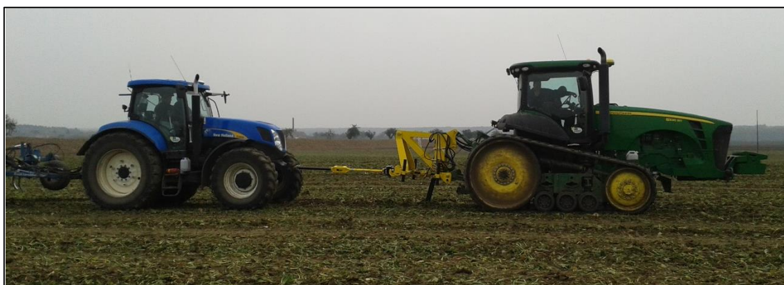
Obrázek 14: Tahová souprava s měřícím zařízením.
