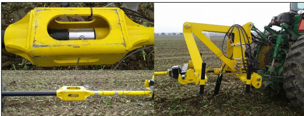
Obrázek 12: Zařízení pro měření tahové síly.
