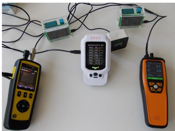
Obrázek 19 - Přístroje měřící hmotnostní koncentrace aerosolových částic
