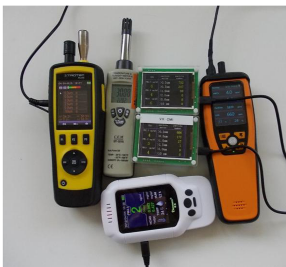
Obrázek 17 - Měření teploty a vlhkosti při rychlé změně podmínek
