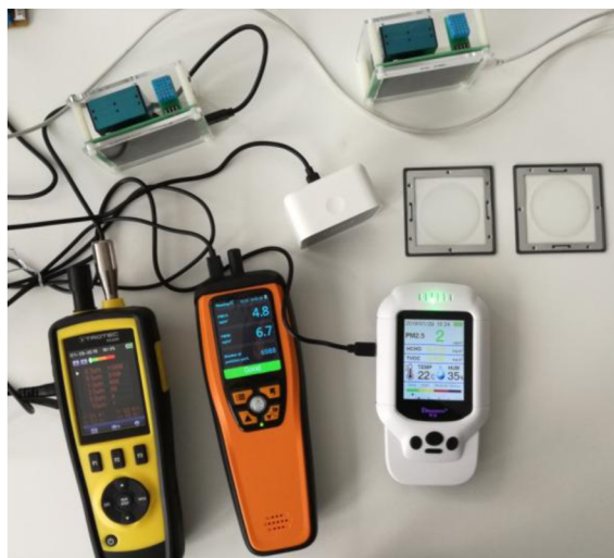
Obrázek 18 - Měření částic ve vnitřním prostředí s filtry
