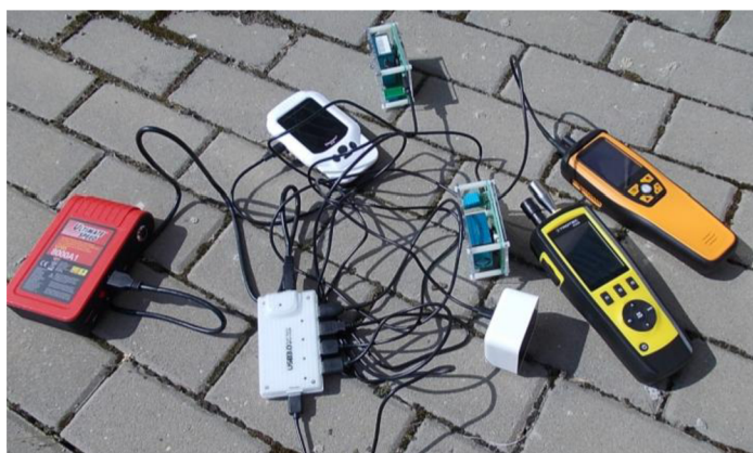
Obrázek 22 - Měření hmotnostních koncentrací částic ve venkovním prostředí
