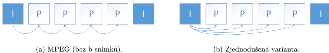
Obrázek 4.5: Zjednodušené kódování rozdílových snímků.
