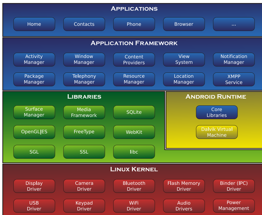
Obrázek 2.4: Architektura platformy Android. Zdroj: Wikipedia
