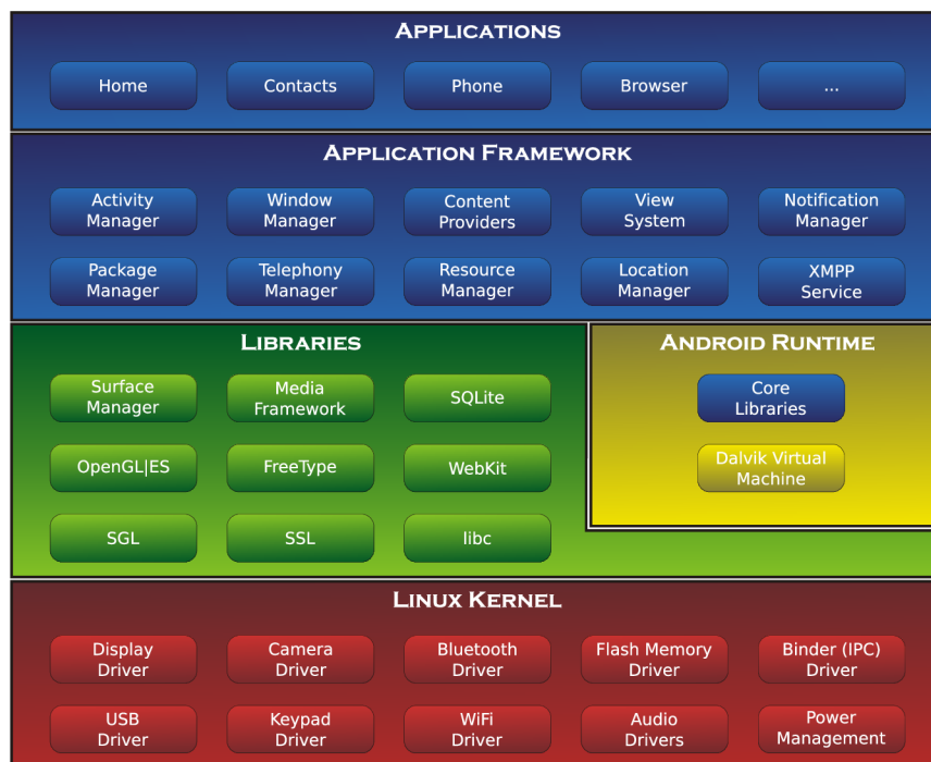
Obrázek 2.4: Architektura platformy Android. Zdroj: Wikipedia
