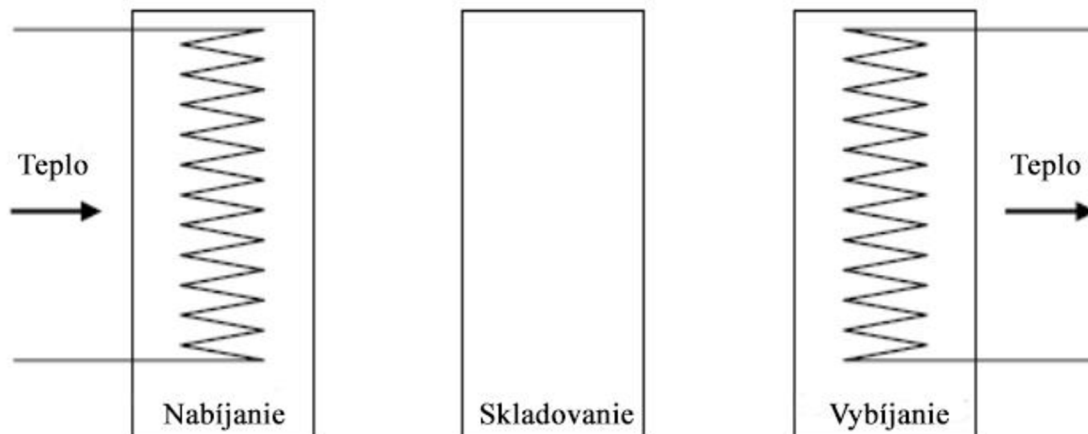
Obr. 1.1 časové úseky skladovanie tepelnej energie [1]
