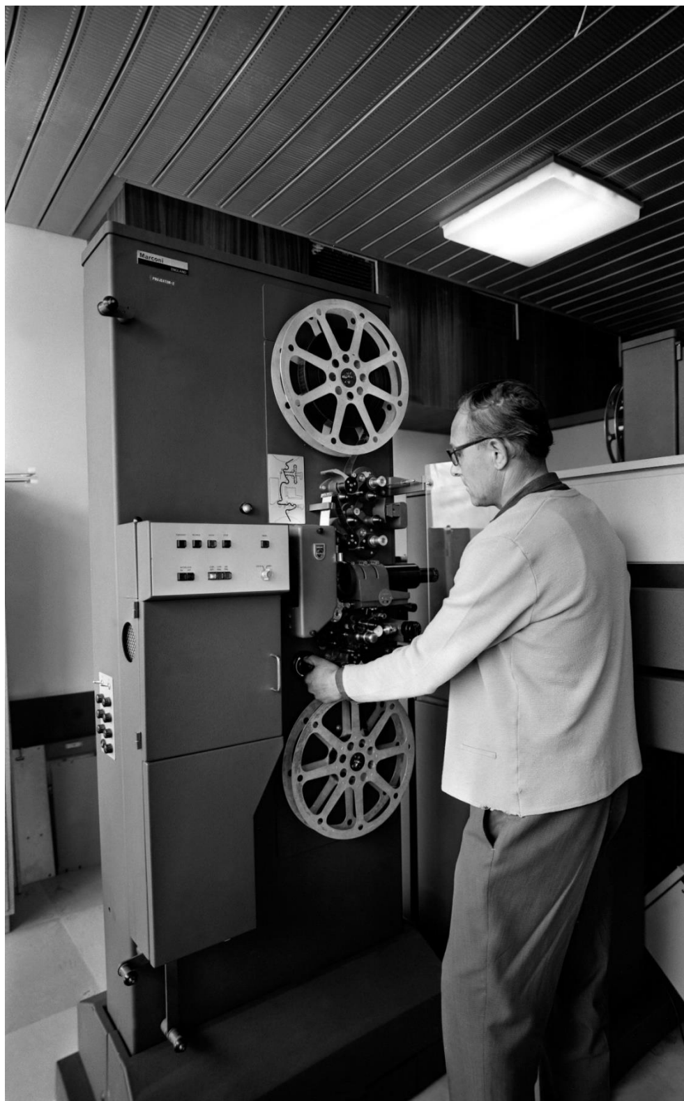
Obrázek 42: Barevný filmový snímač Marconi v televizním centru Mlynská dolina
