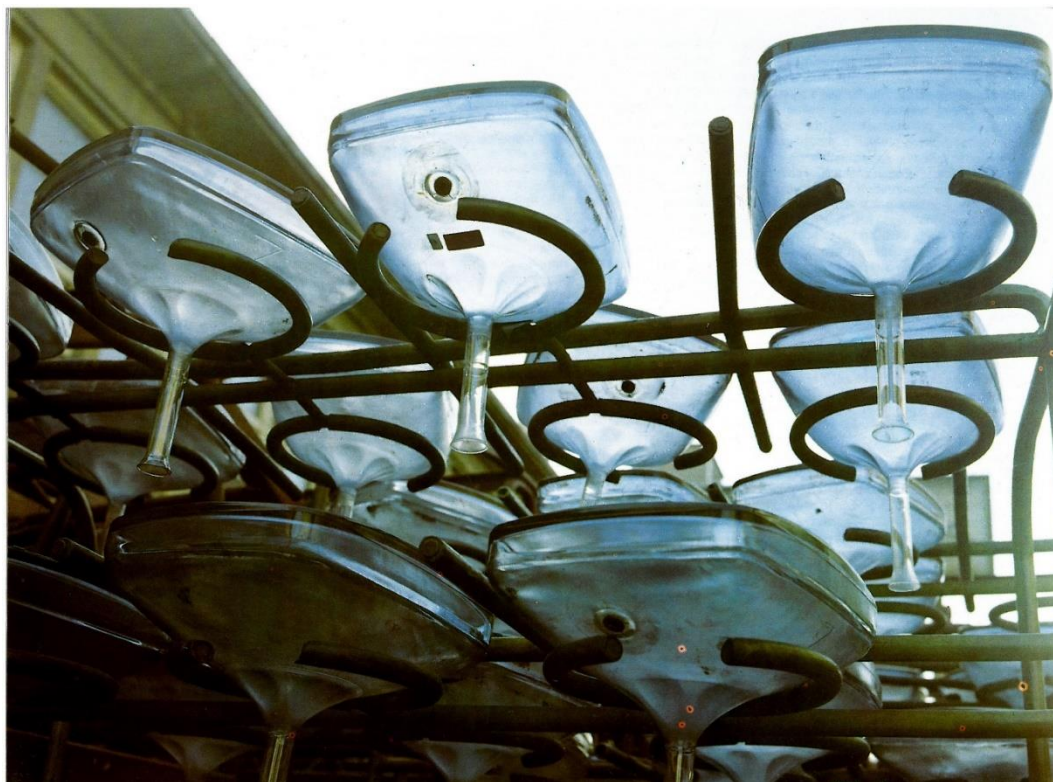
Obrázek 20: Skleněné díly pro výrobu televizních obrazovek v Tesle Rožnov
