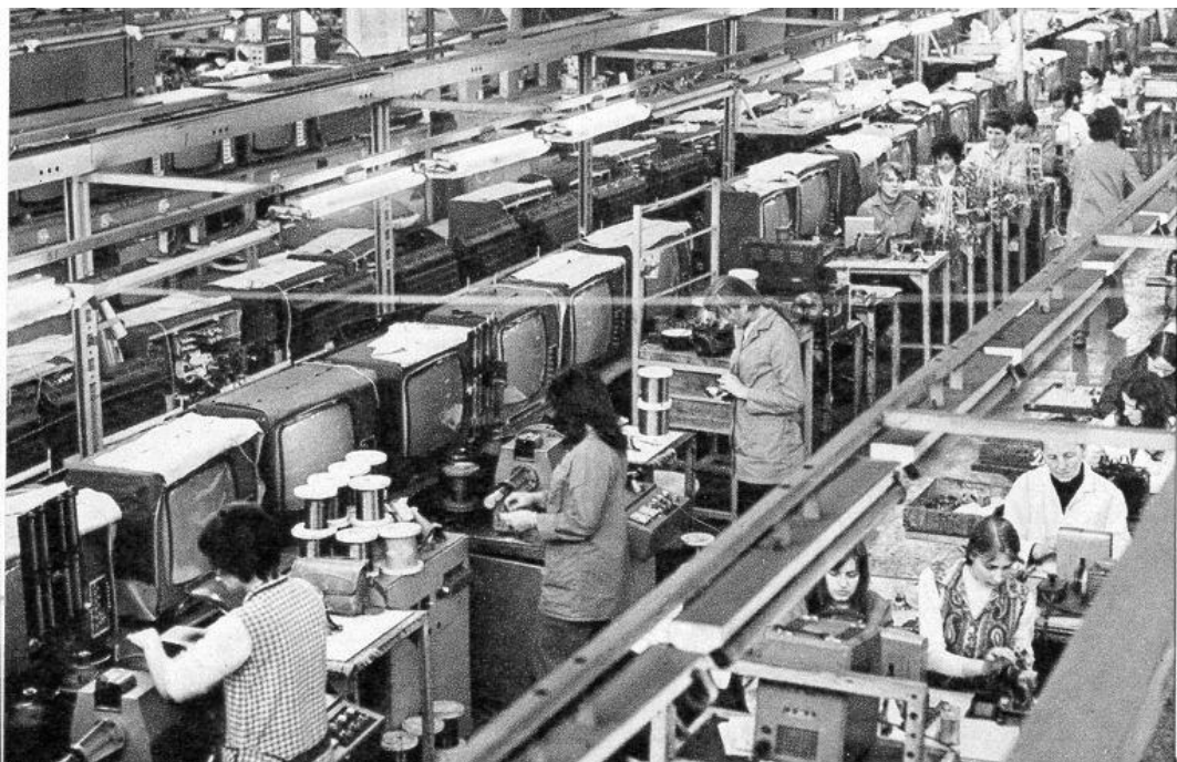
Obrázek 10: Výroba barevných televizorů Tesla 4401A Color v Tesle Orava
