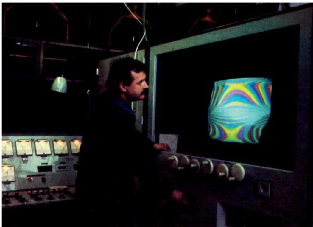
Obrázek 24: Měření optických a elektrických parametrů obrazovek v Tesle Rožnov
