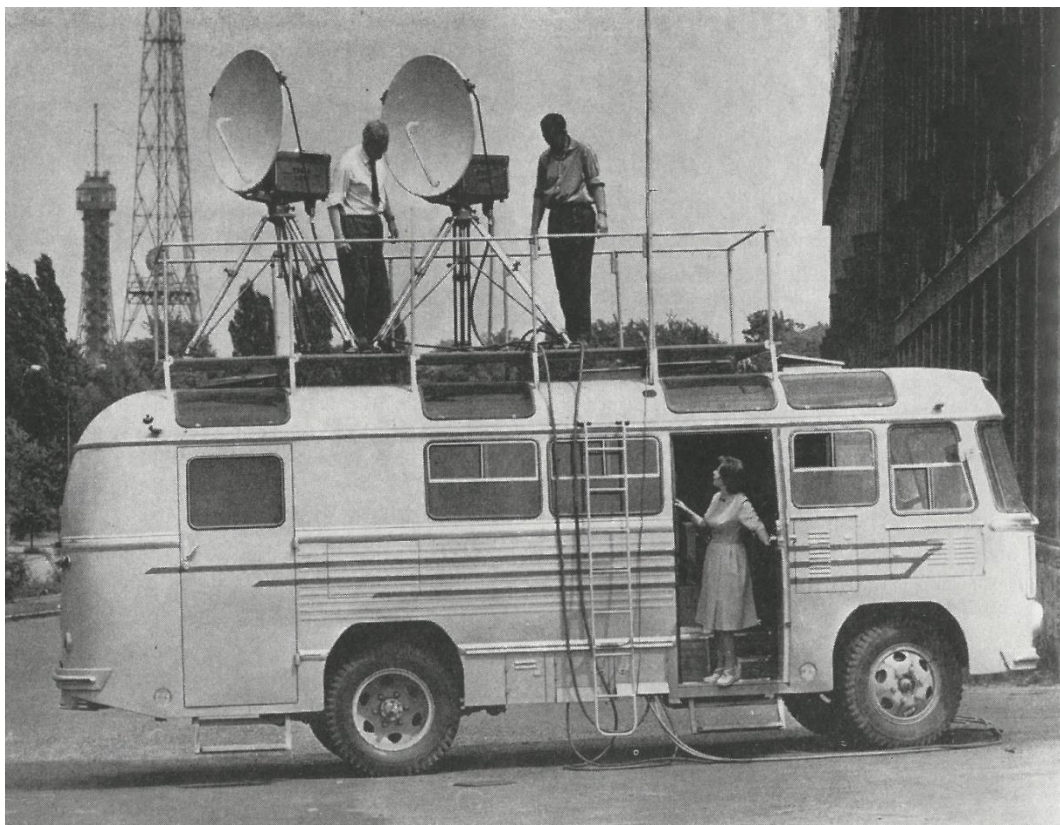
Obrázek 29: Retranslační vůz vybavený zařízením Tesla MT 11
