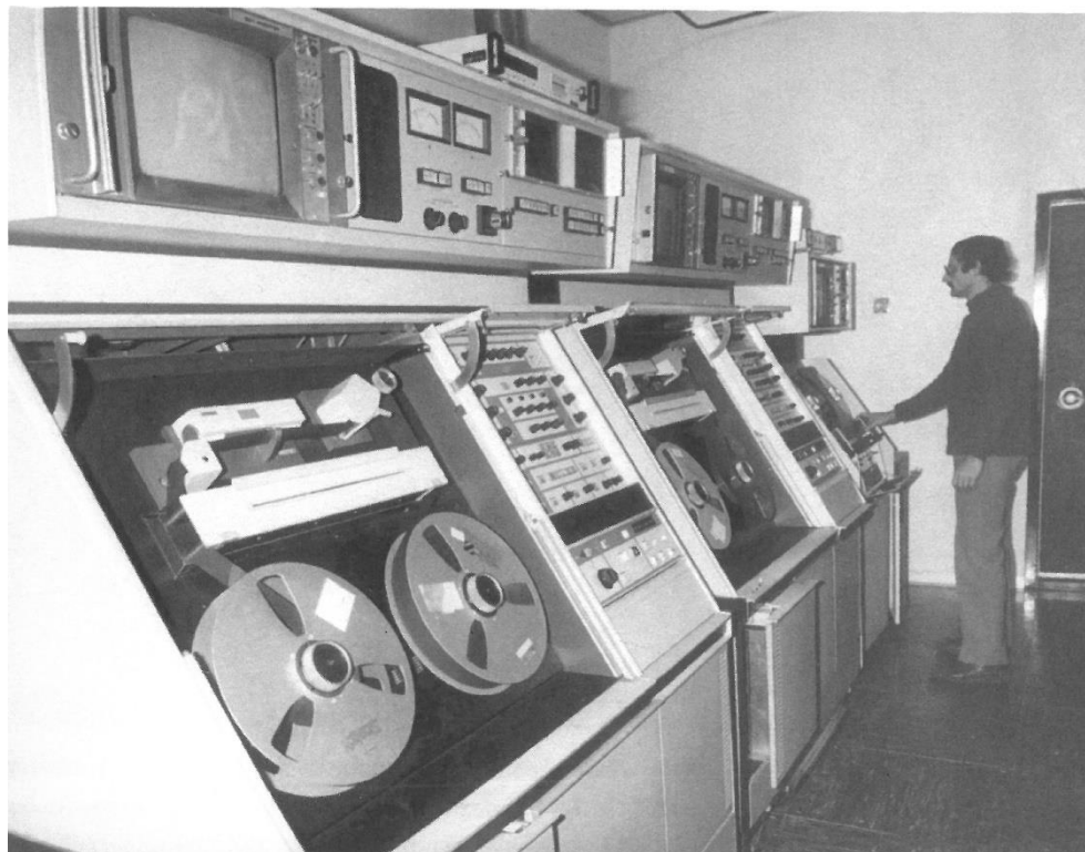
Obrázek 36: Pracoviště magnetického záznamu ODK 3 se stroji Ampex AVR1
