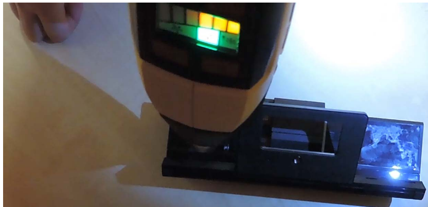
Obrázek 34: Nahřátí polepů pro snadné odstranění
