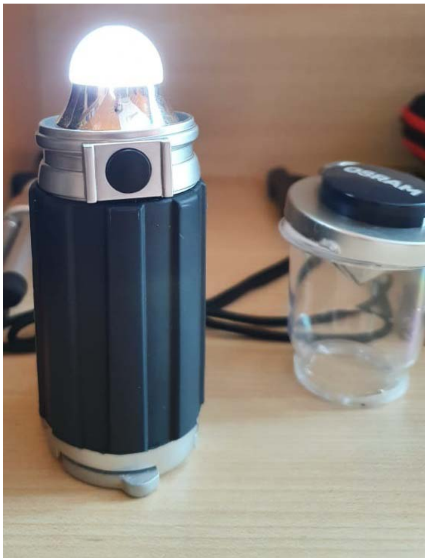
Obrázek 61: Upravená svítilna pro použití jako světelná značka
