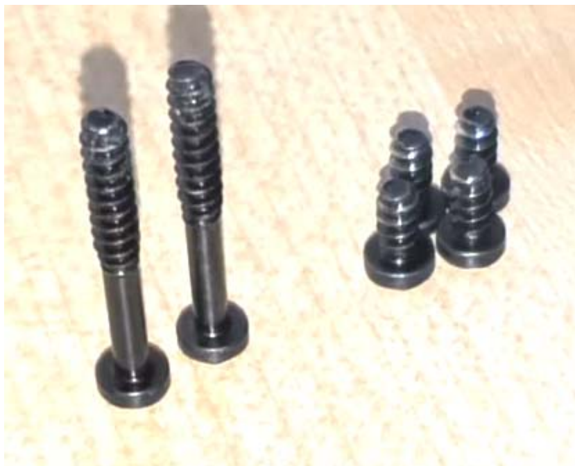
Obrázek 37: Rozdílné délky Bezpečnostních Torx 10 (nalevo) a torx 10 (napravo)
