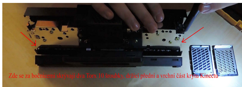
Obrázek 38: Odebrání dvou skrytých Torx 10 šroubků držících přední a vrchní část krytu Kinectu
