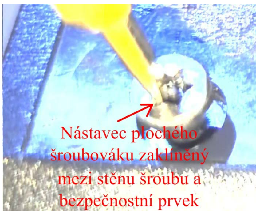
Obrázek 36: Odšroubování bezpečnostního Torx pomocí malého plochého šroubováku
