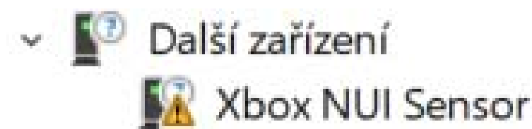
Obrázek 17: První zapojení Kinect v2 - bez Kinect for Windows SDK 2.0
