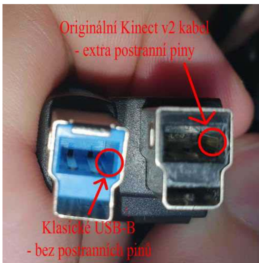
Obrázek 31: Klasické USB-B 3.0 vs. originální Kinect v2 kabel
