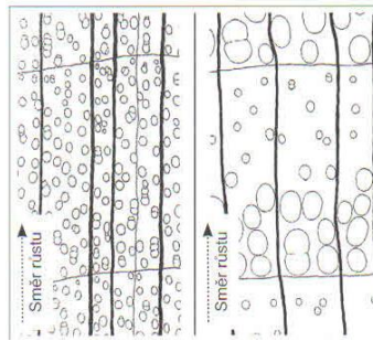
Obr. 3: Rozdělení dřev listnáčů – vlevo roztroušeně pórovité, vpravo s kruhovitě pórovitou strukturou (Kyncl 2017)
