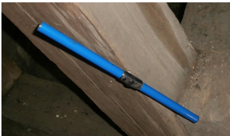
Obr. 13: Odběr vzorku pomocí Presslerova přírůstového nebozezu
