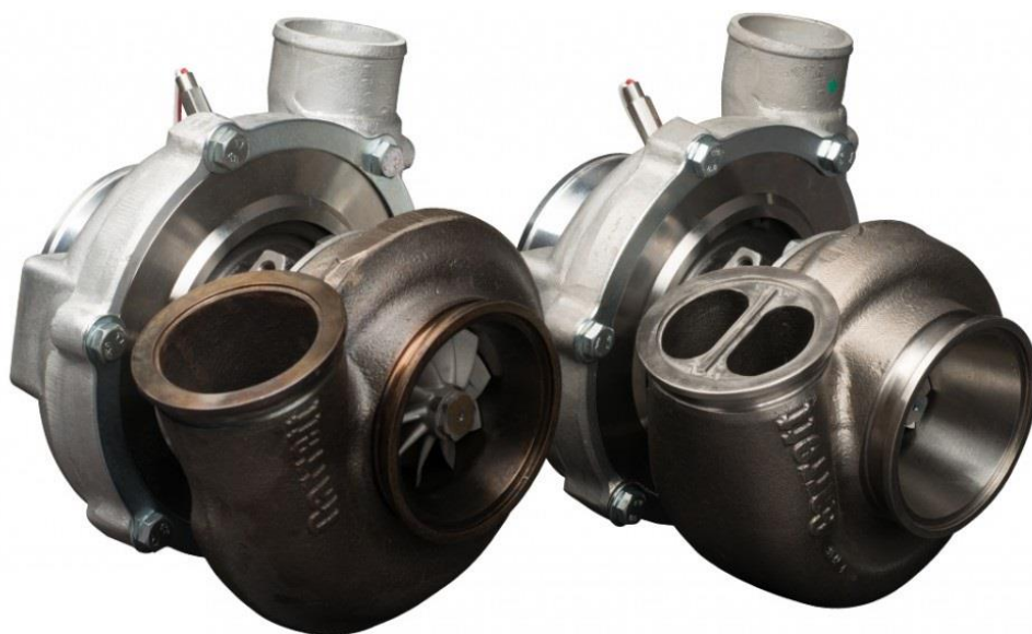
Obr. 12 Otevřená skříň (vlevo), dělená skříň (vpravo) [16]
