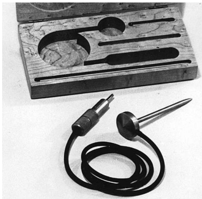
Obr. 2: Pravděpodobně první komerčně vyráběný piezoelektrický akcelerometr, B&K Model 4303 (převzato ze zdroje [10]).
